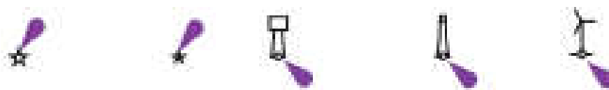
Slika 43. Označavanje položaja svjetlosnih signala [15]
