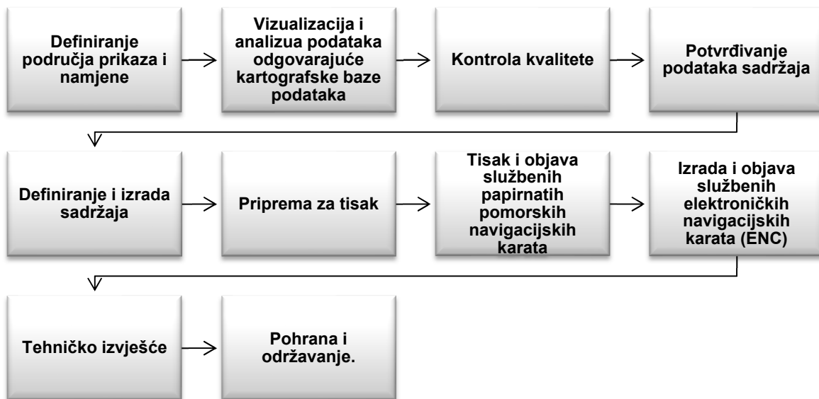
Slika 3. Postupak izrade pomorskih karata [14]
