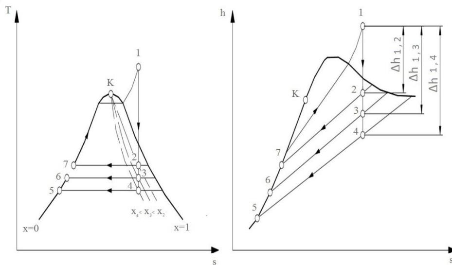
**Slika 25. Povećanje rada smanjenjem tlaka u kondenzatoru [13]**
