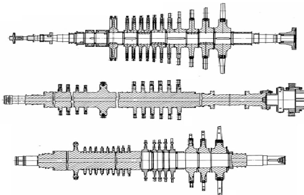
Slika 20. Prikaz konstruktivnih izvedbi rotora parnih turbina [2]
