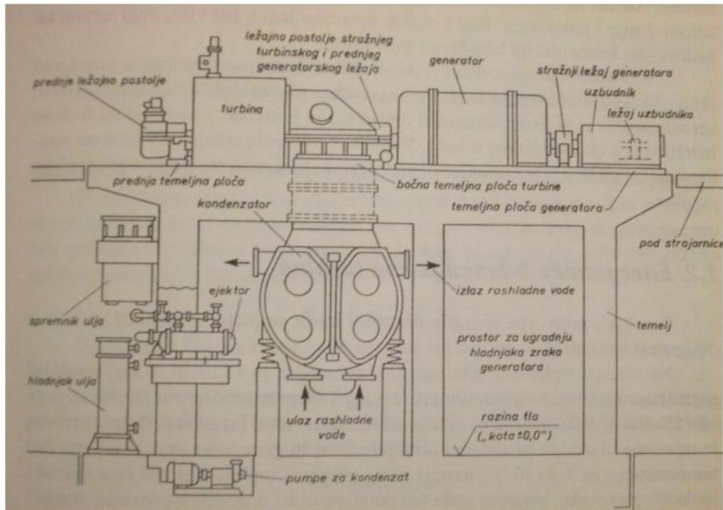
**Slika 9. Raspored opreme kondenzacijskog turbo agregata srednje snage [2]**
