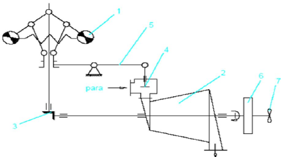
**Slika 27. Načelna shema sustava za regulaciju brzine vrtnje [13]**
