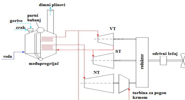
**Slika 11. Pojednostavljeni prikaz sustava s međupregrijačem pare [4]**
