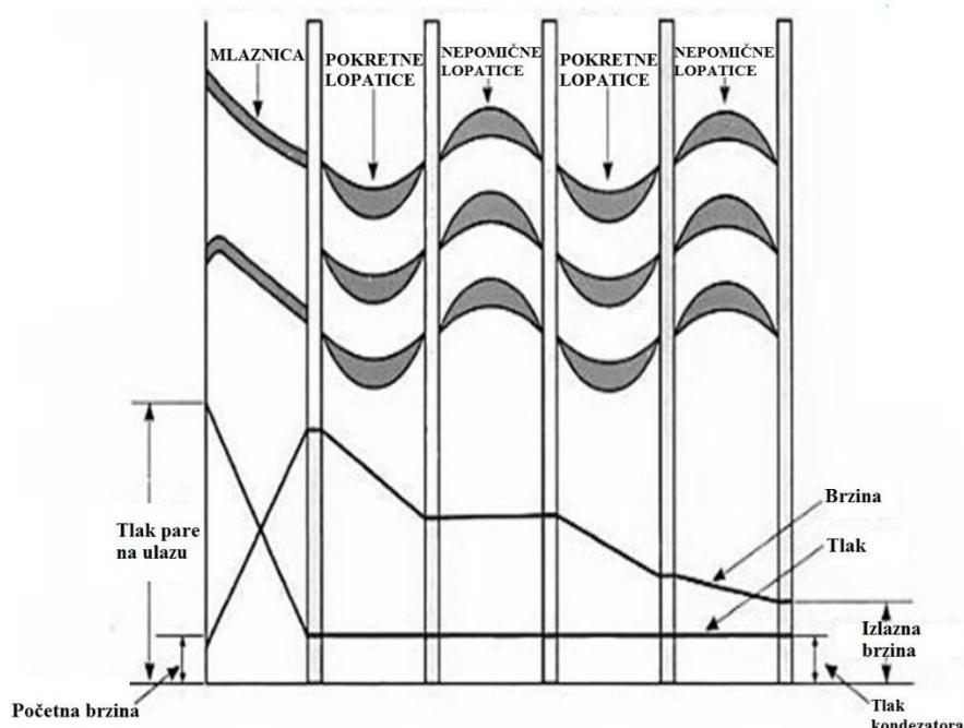
**Slika 15. Kombiniranje brzine u impulsnoj turbini [15]**
