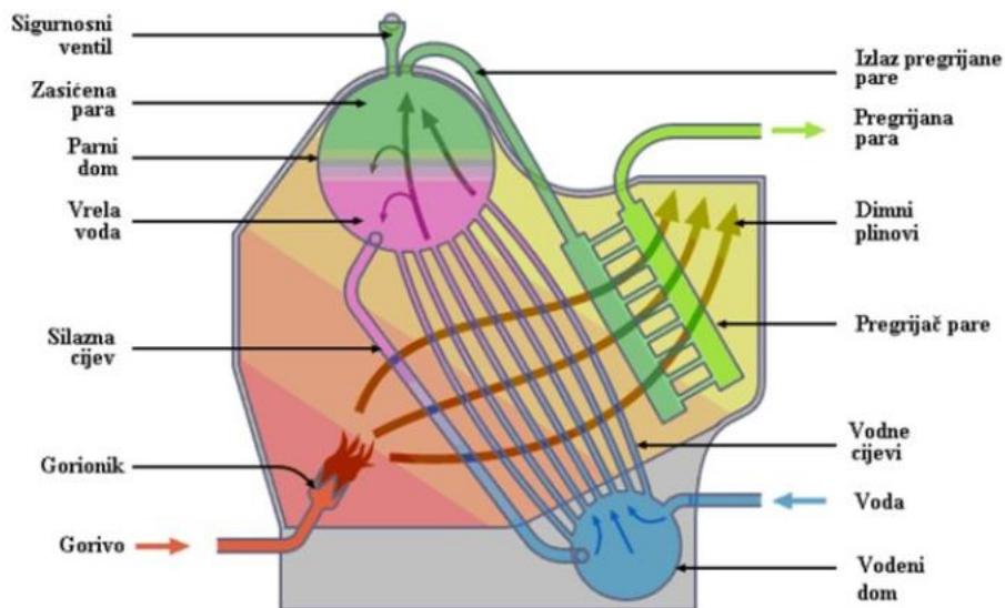
**Slika 10. Vodocijevni generator pare [4]**
