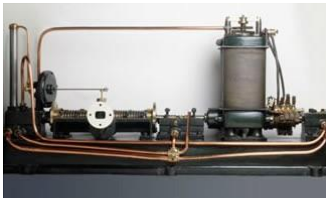
Slika 6. Parsonsova parna turbina[2]
