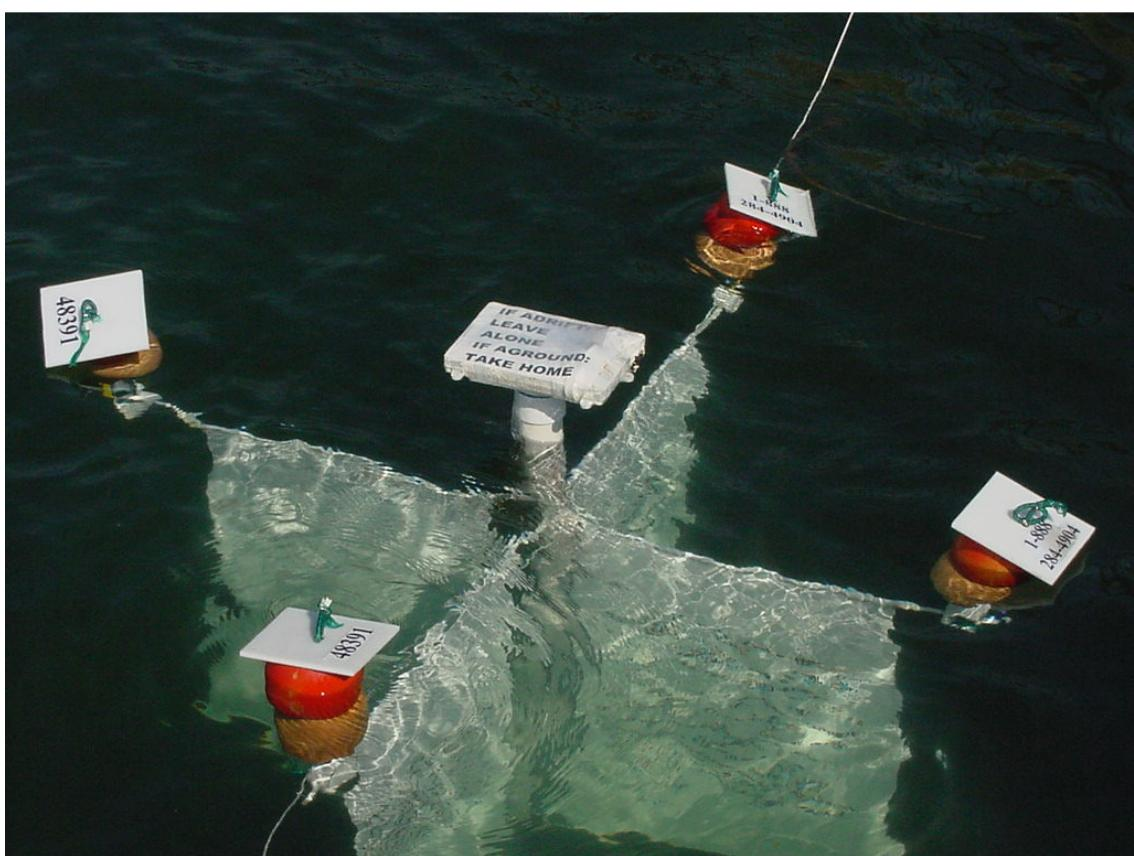
**Slika 3. Lagrangeova metoda- satelitiski praćeni površinski drifter [6]**
