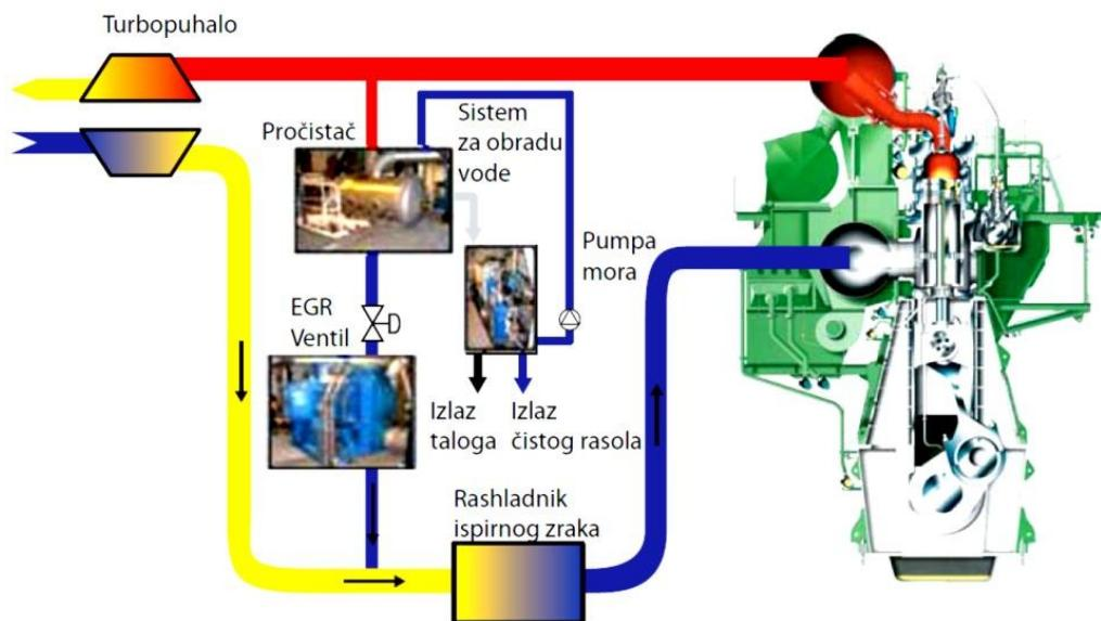
**Slika 15. Shematski prikaz sistema recirkulacije ispušnih plinova EGR [5]**
