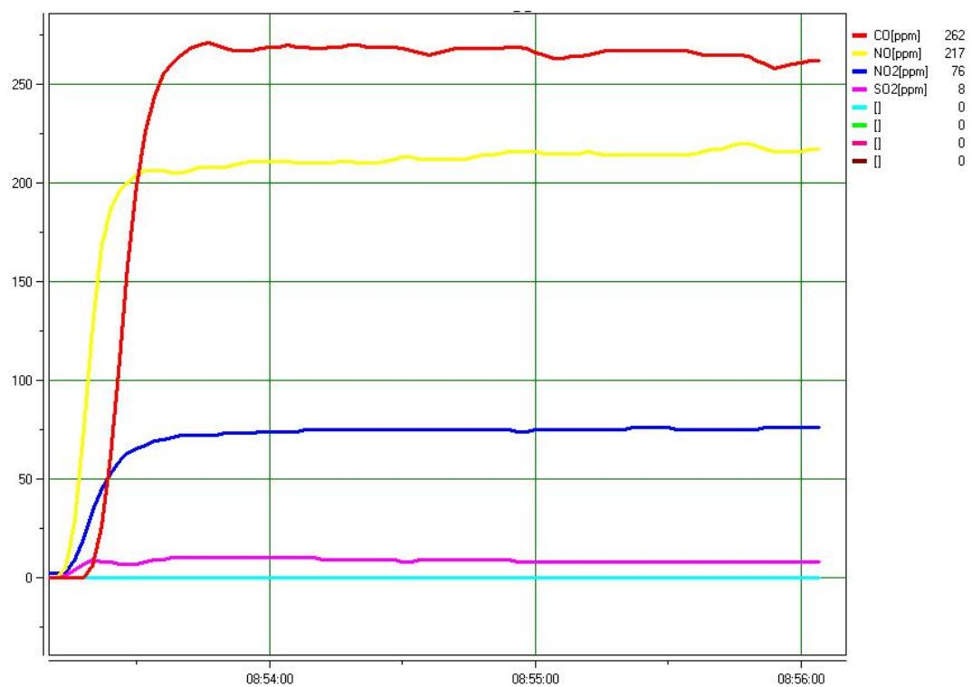
Slika 29. Grafički prikaz CO, NO, NO<sub>2</sub> i SO<sub>2</sub> za lijevi motor
