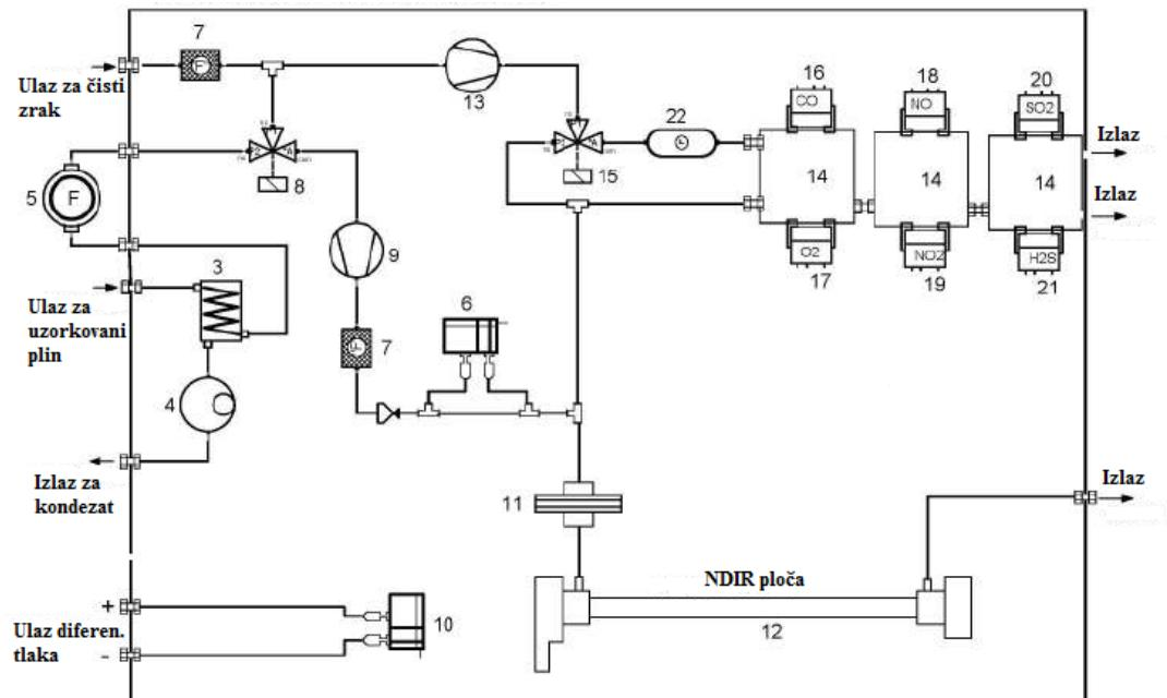
Slika 22. Shematski prikaz protoka plina kroz analizator [13]
