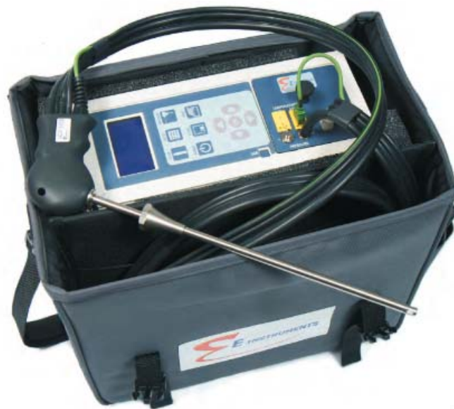
Slika 18. E8500 MK emisijski analizator [10]
