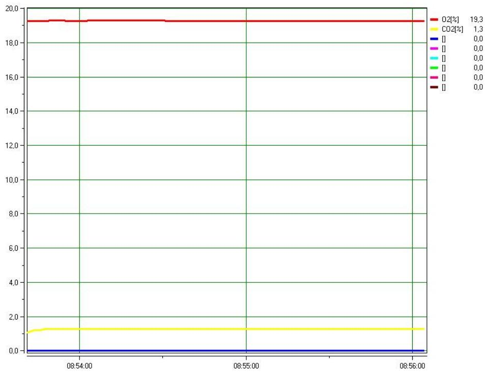
**Slika 27. Grafički prikaz O<sub>2</sub> i CO<sub>2</sub> za lijevi motor**
