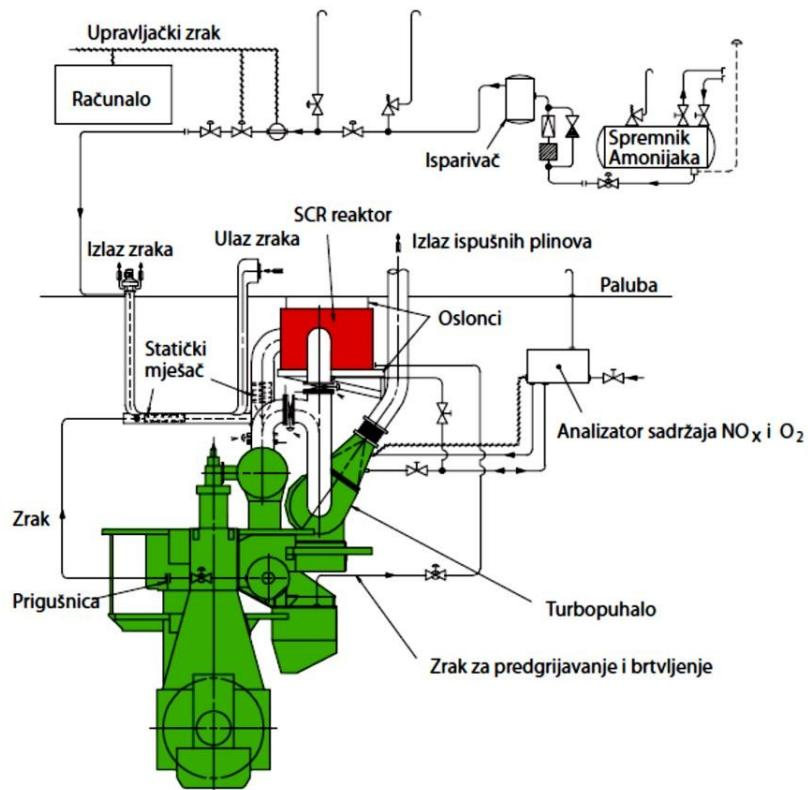
Slika 16. Shematski prikaz selektivnog katalitičkog reaktora SCR [5]
