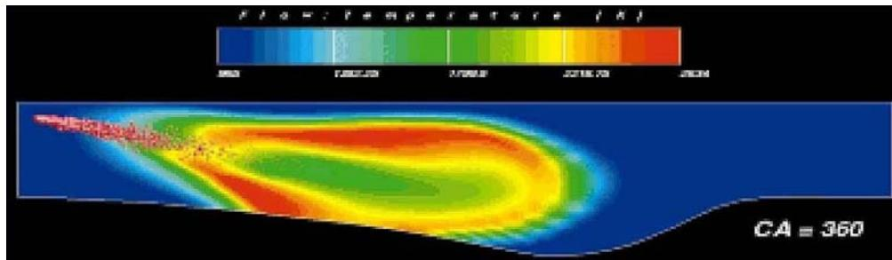
Slika 7. Raspored temperatura u zoni izgaranja srednjokretnog motora [5]
