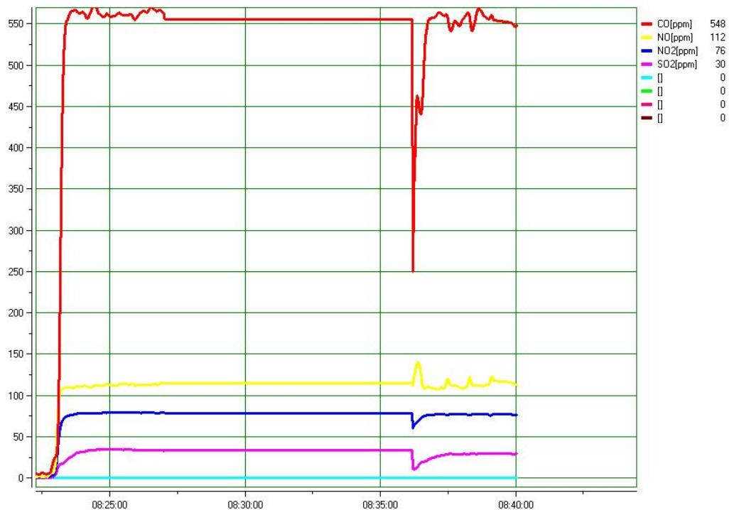
Slika 30. Grafički prikaz CO, NO, NO<sub>2</sub> i SO<sub>2</sub> za desni motor
