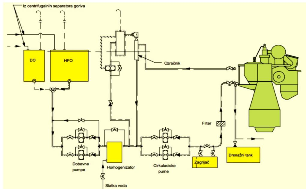
**Slika 12. Položaj homogenizatora u sustavu goriva glavnog motora [5]**
