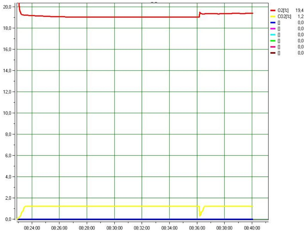
**Slika 28. Grafički prikaz O<sub>2</sub> i CO<sub>2</sub> za desni motor**
