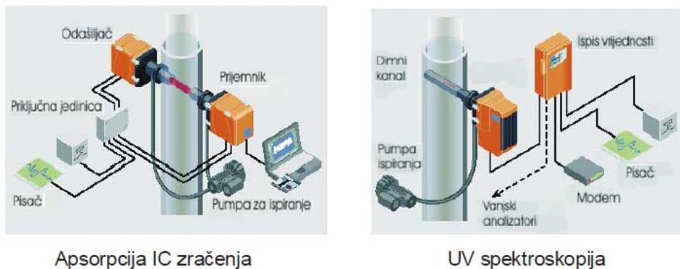
Slika 17. Analizator za kontinuirano mjerena emisije štetnih plinova [9]
