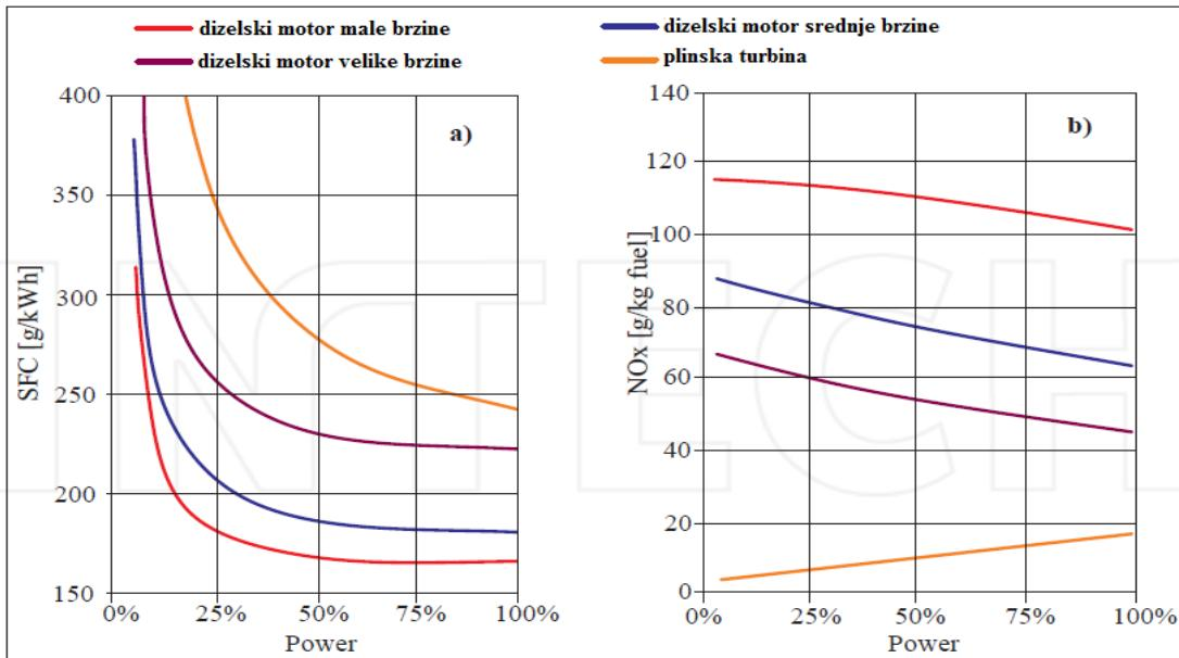
Slika 4. a) Specifična potrošnja goriva porivnih strojeva b) Omjer emisije NO<sub>x</sub> za porivne strojeve [8]
