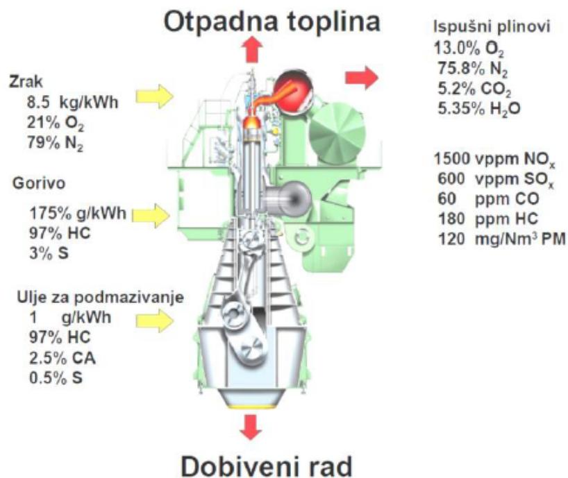
Slika 5. Tipičan sastav emisije ispušnih plinova sporokretnog dvotaktnog motora tipa
