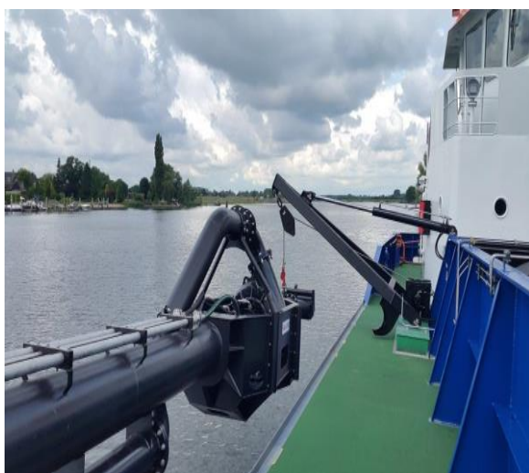
Slike 79. i 80. Pogonski sklop podvodne pumpe u usisnoj cijevi [32]
