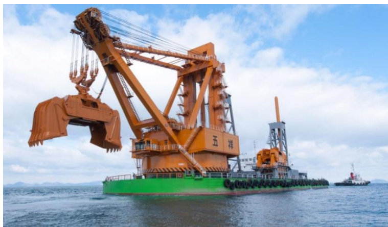
Slika 36. GOSHO, jaružalo s najvećom grabilicom od 200 m 3 [34]
