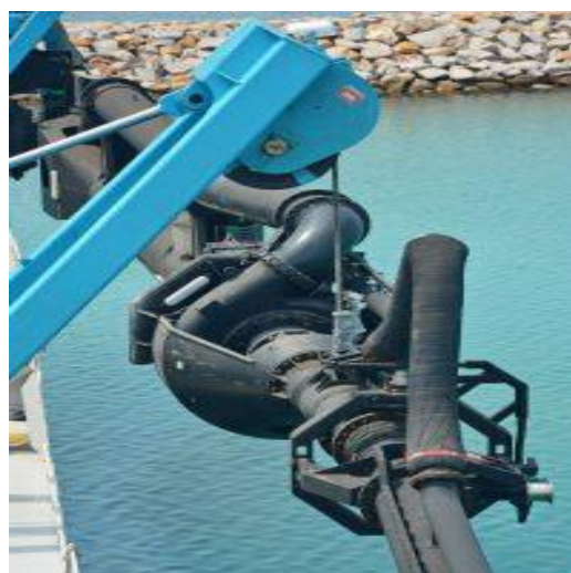
Slike 79. i 80. Pogonski sklop podvodne pumpe u usisnoj cijevi [32]
