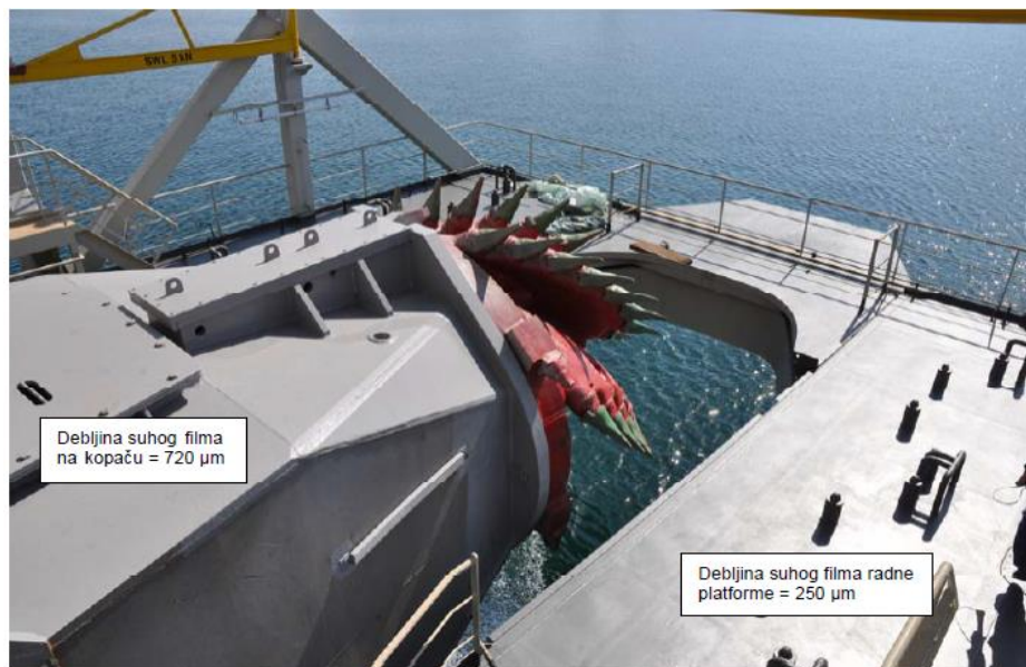
Slika 85. Kopač zaštićen silikonskim premazom, Brodogradilište Uljanik, Pula, svibanj 2010. [1]
