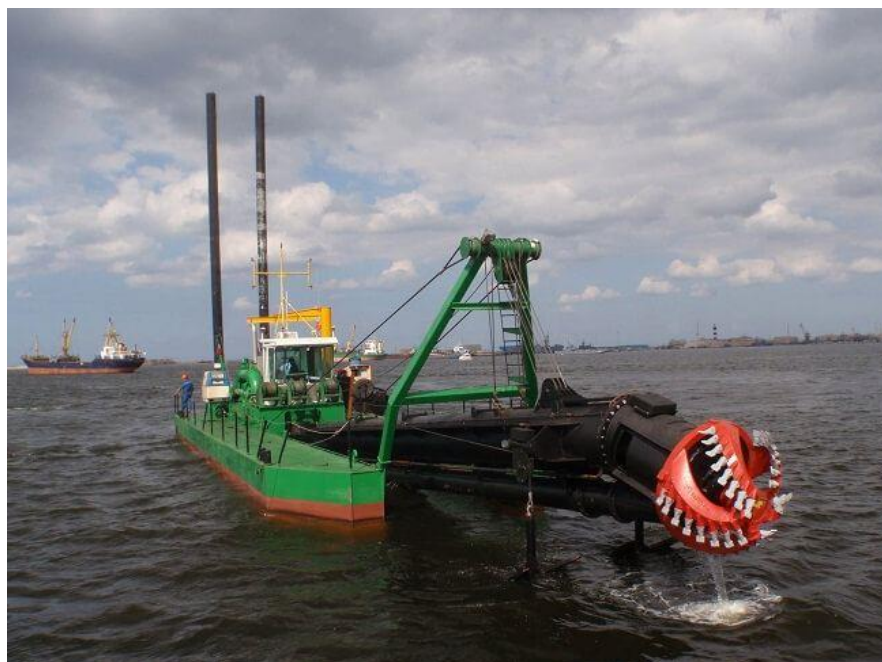
Slika 9. Usisno jaružalo s rezačem [39]
