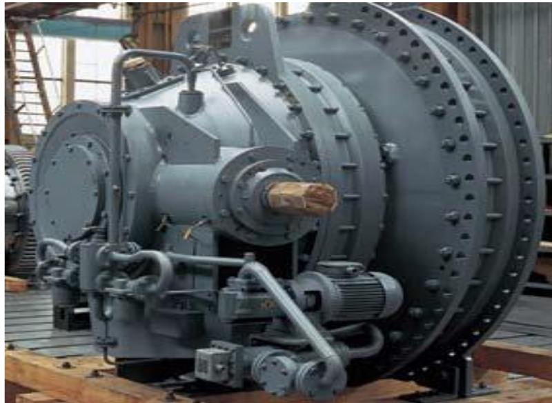
Slika 22. Planetarni prijenosnik kotača s vjedrima [35]
