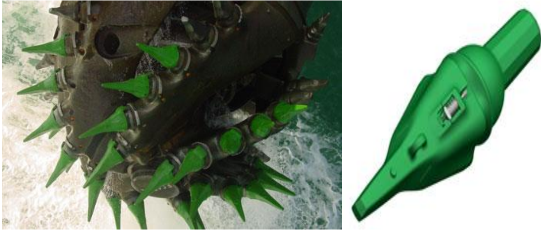
Slike 61. i 62. ESCO Spherilok® rezač za kamen i sustav zuba [26]
