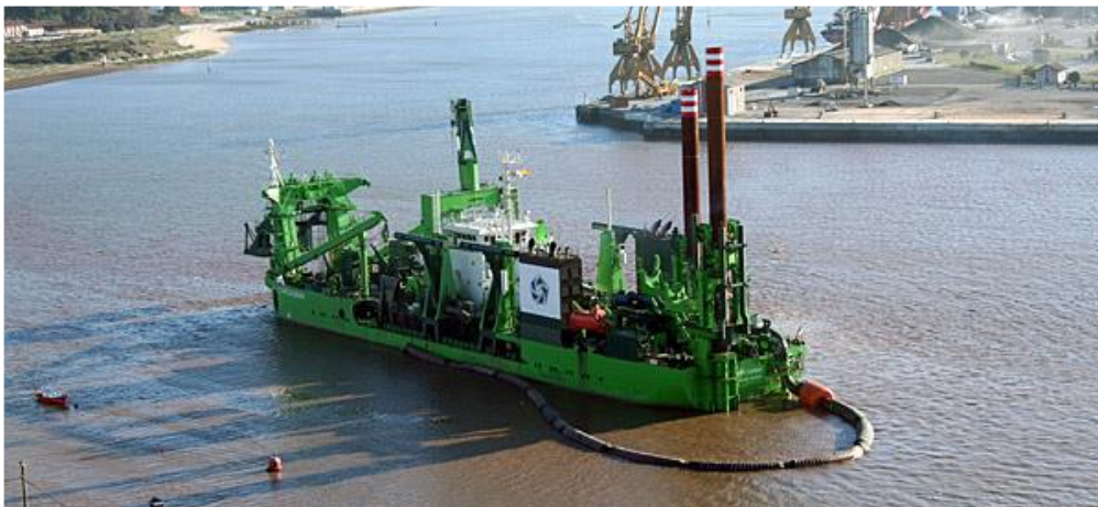
Slika 3. Iskrcaj iskapanog tereta preko plutajućeg cjevovoda [9]
