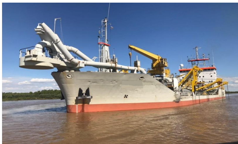
Slika 70. Mlaznica za rainbowing i cijev za isporuku s priključkom za obalni cjevovod [23]
