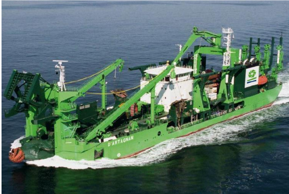
Slika 50. D'Artagnan usisno jaružalo opremljeno sjekačem [8]
