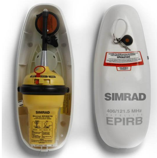
Slika 25. Prikaz Simrad Pro EPIRB EP70 IMO SOLAS plutače [25]
