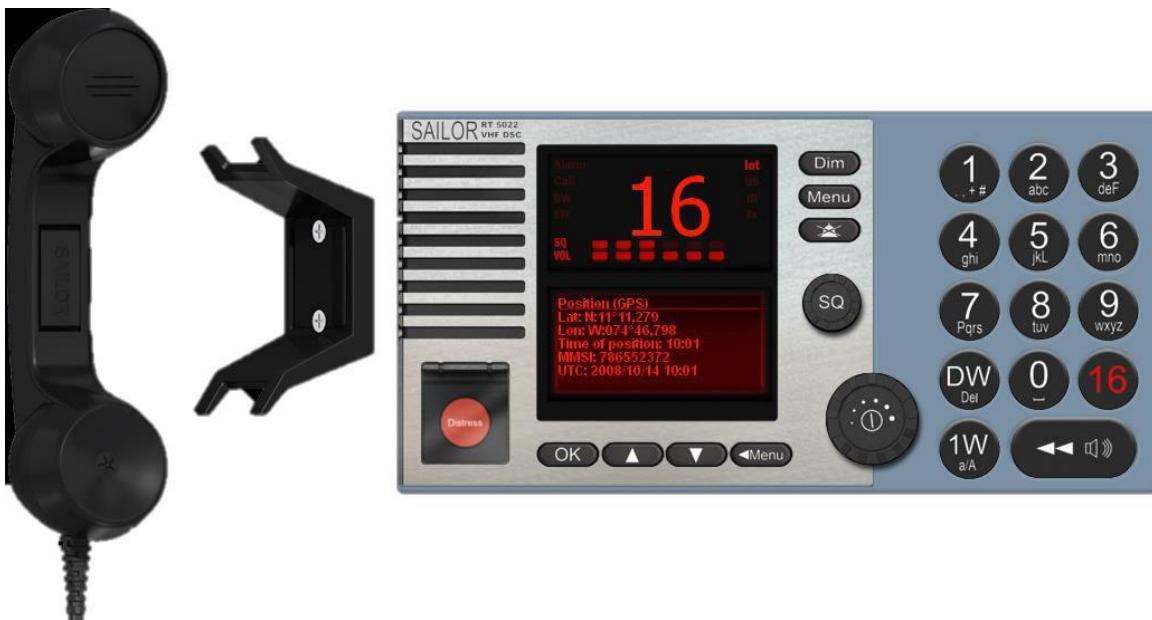
Slika 6. Primjer VHF DSC uređaja, model SAILOR RT 5022 [17]
