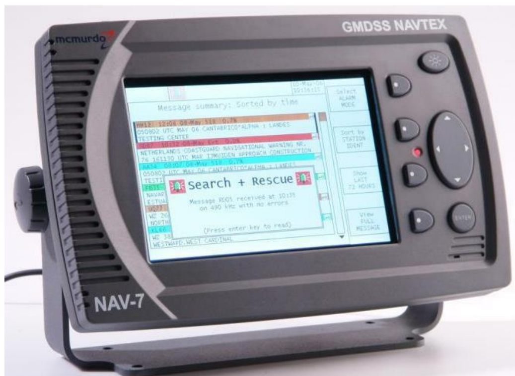
Slika 12. Primjer NAVTEX uređaja, McMurdo NAV-7 [22]
