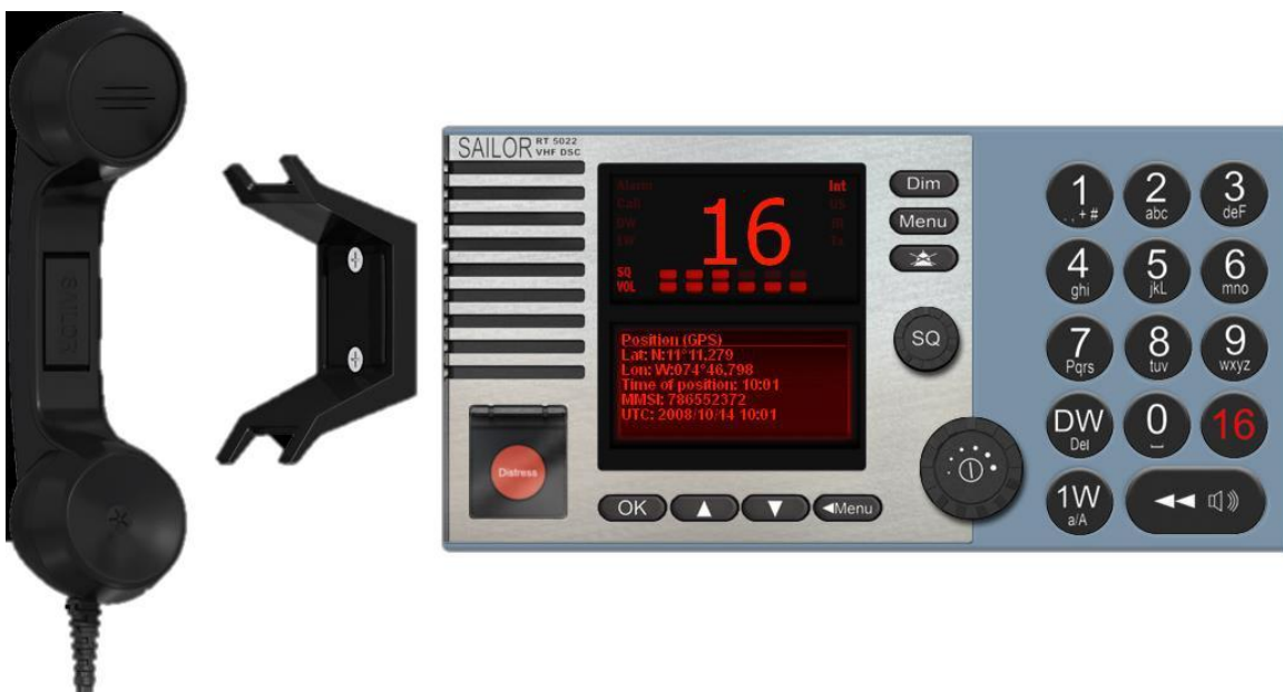
Slika 6. Primjer VHF DSC uređaja, model SAILOR RT 5022 [17]
