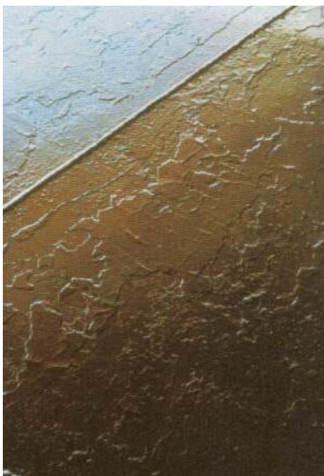
Slika 8. Pojava sandwich premaza
