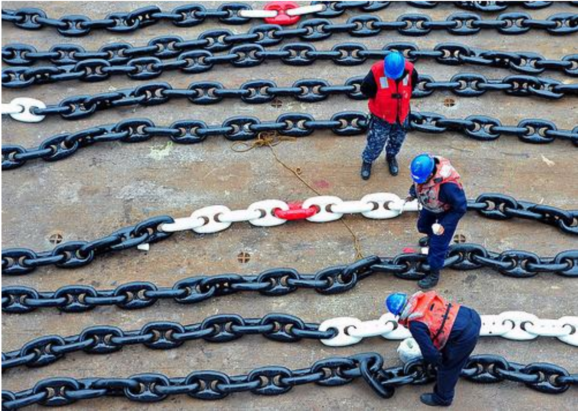
Slika 17. Označavanje uza na sidrenom lancu [22]
