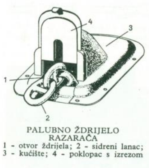
Slika 14. Palubno ždrijelo razarača [9]
