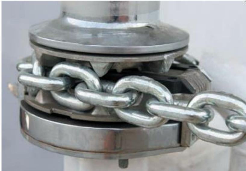
Slika 25. Barbotin - lančano kolo [1]
