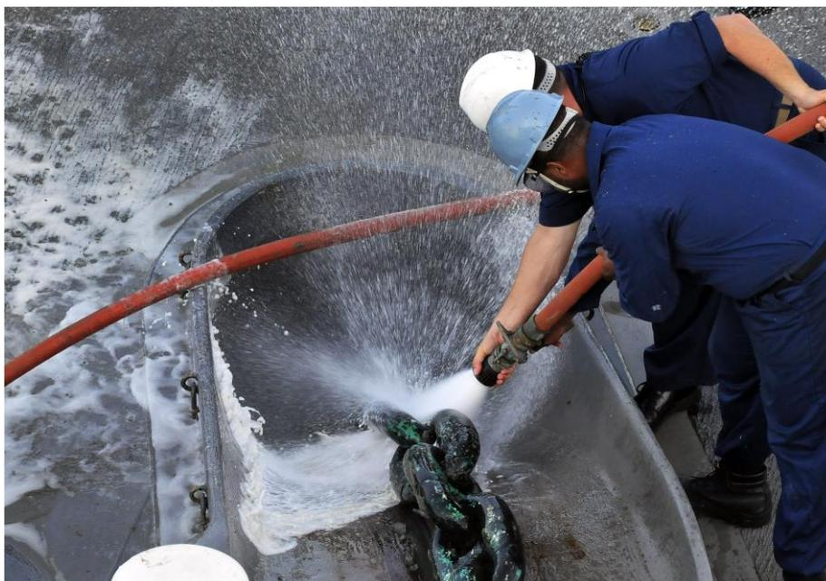
Slika 18. Pranje sidrenog lanca protupožarnim mlaznicama [21]
