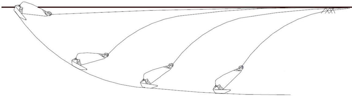
Slika 30. Ukopavanje sidra u dno povlačenjem [1]
