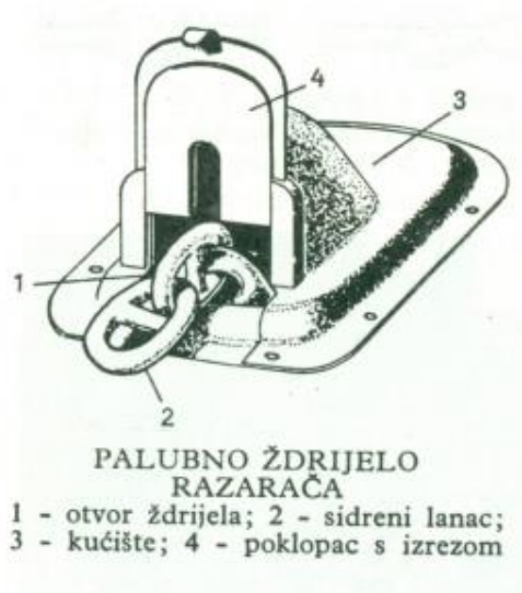
Slika 14. Palubno ždrijelo razarača [9]
