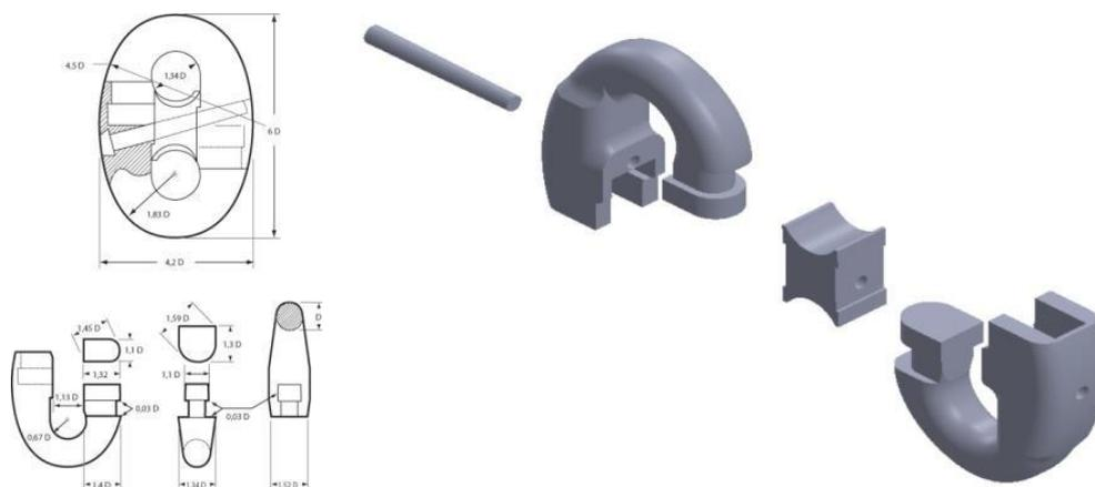
Slika 16. Patentna spojna karika tipa kenter [1]
