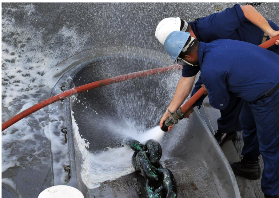
Slika 18. Pranje sidrenog lanca protupožarnim mlaznicama [21]
