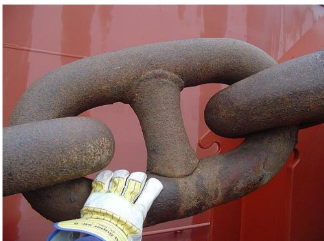
Slika 15. Karika sidrenog lanca na brodu većih dimenzija [9]
