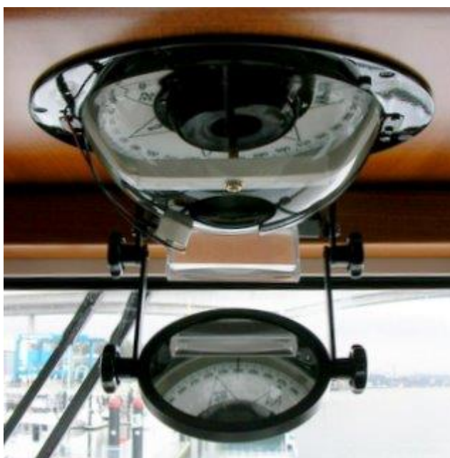
Slika 11. Kompas ugrađen na strop kormilarnice [15]
