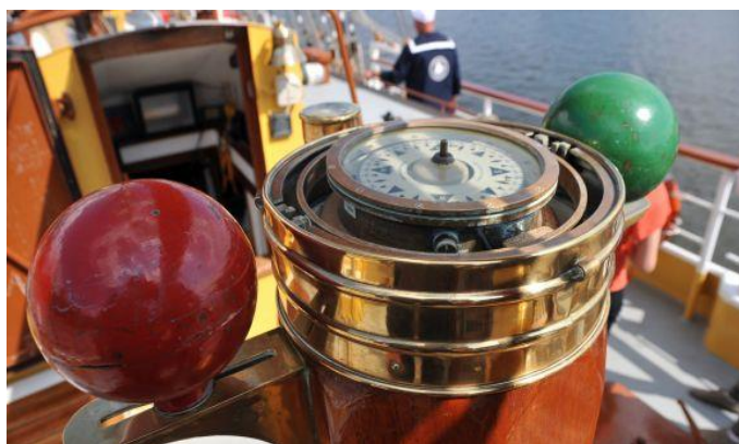
Slika 12. Magnetski kompas na brodu [6]
