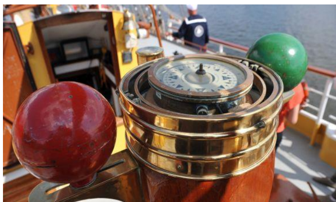
Slika 12. Magnetski kompas na brodu [6]
