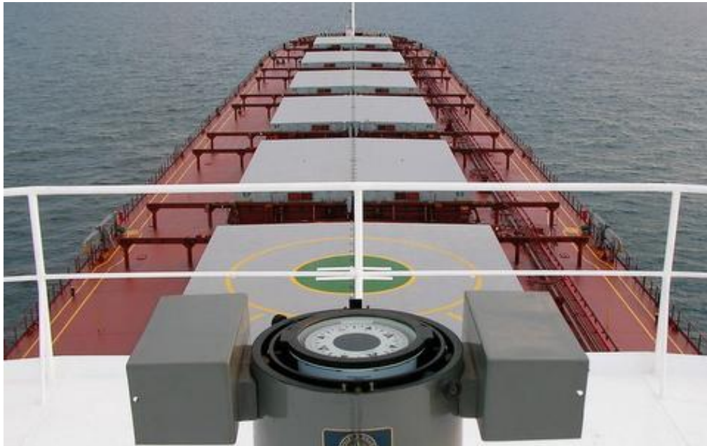
Slika 9. Instalacija kompasa na "Monkey Island" na uzdužnicu broda [15]
