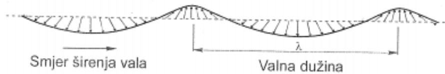
Slika 12. Prikaz stanja titranja Reyleighovih valova [1]
