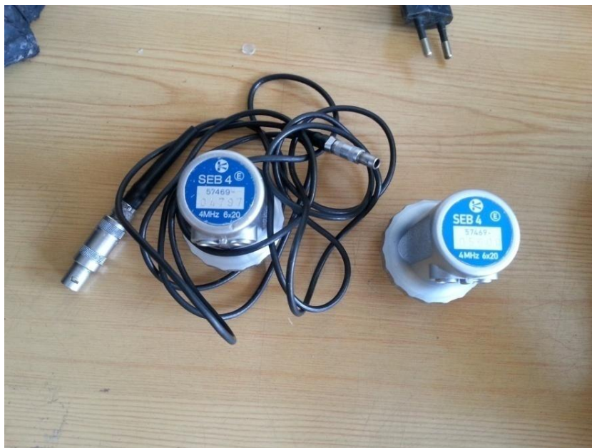
Slika 24. Sonda sa dva pretvarača. Model SEB 4
