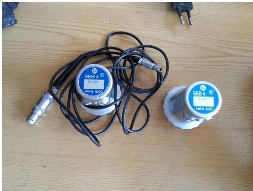
Slika 24. Sonda sa dva pretvarača. Model SEB 4
