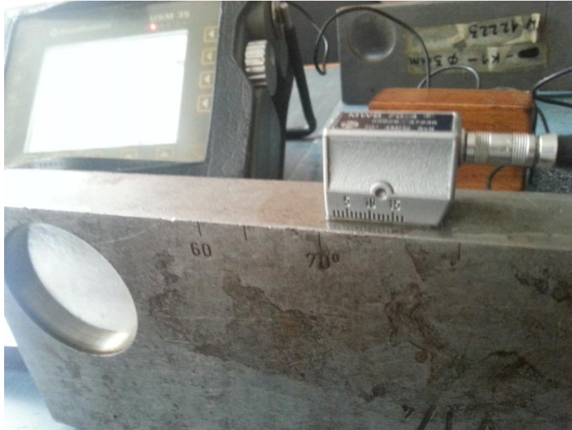
Slika 34. Određivanje kuta sonde
