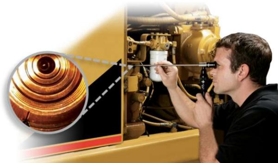
Slika 1. Primjena boreskopa s uzorkom slike dobivene pregledom
