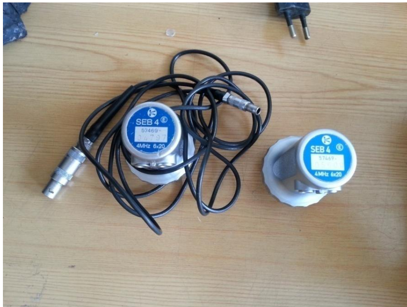
Slika 24. Sonda sa dva pretvarača. Model SEB 4
