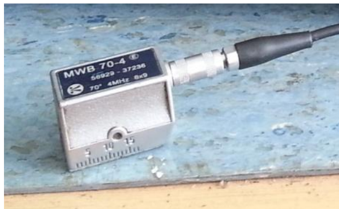
Slika 27. Kutna sonda MWB 70-4
