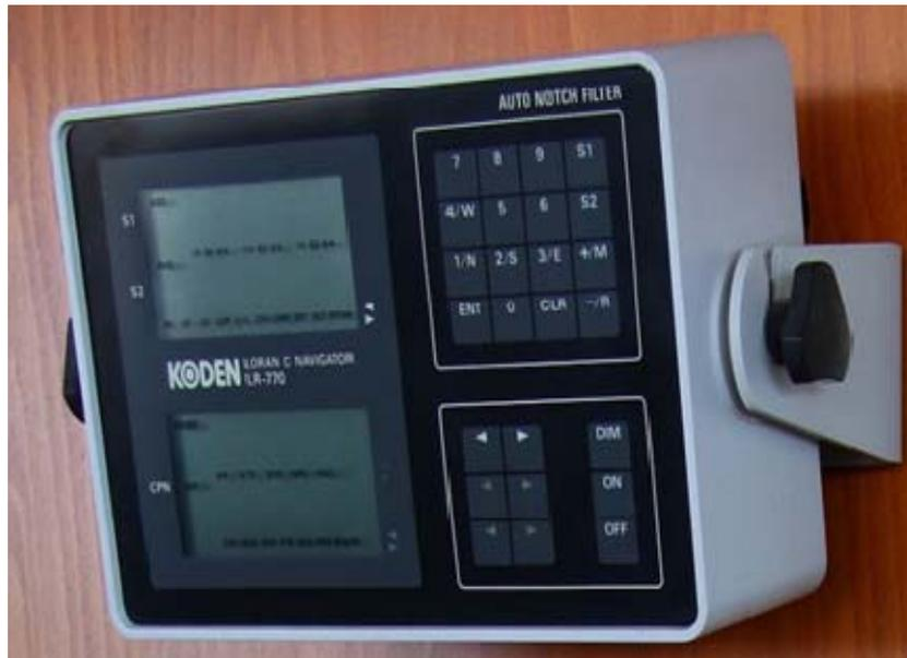
**Slika 1. LORAN primač signala [21]**
