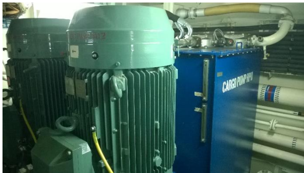
Slika 47. Hidraulični set za napajanje pumpi i agitatora [32]
