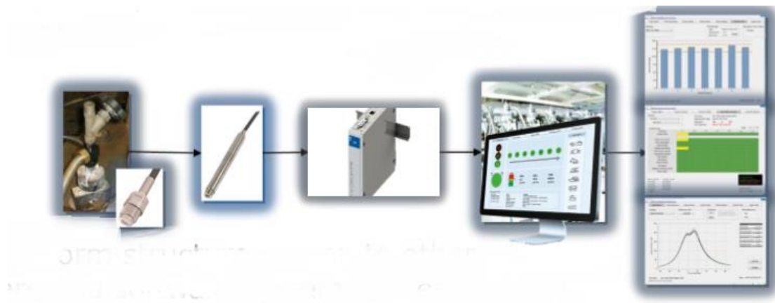
Slika 21. AVL EPOS lanac mjerenja [9]
