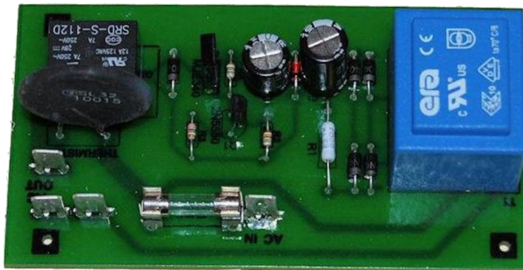
Slika 12. Jednostrana tiskana pločica
