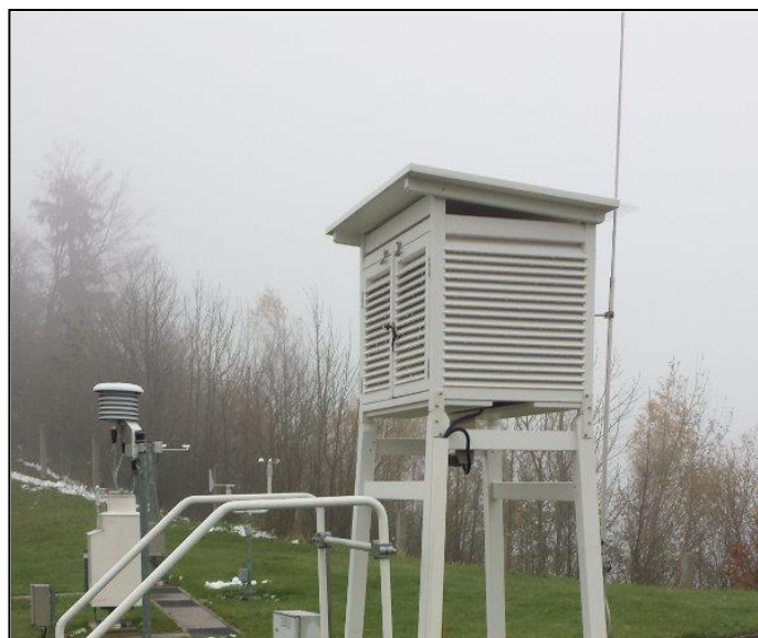
Slika 6. Kućica za mjerenje temperature zraka
