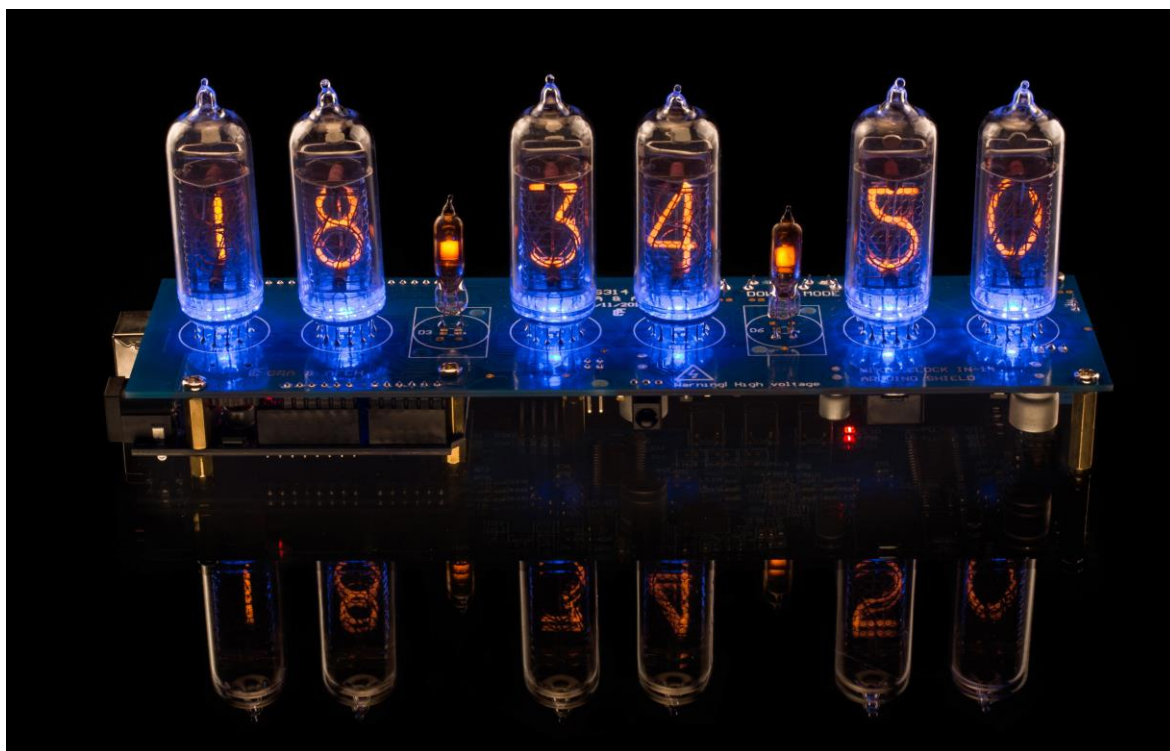
Slika 11. Nixie sat i termometar
