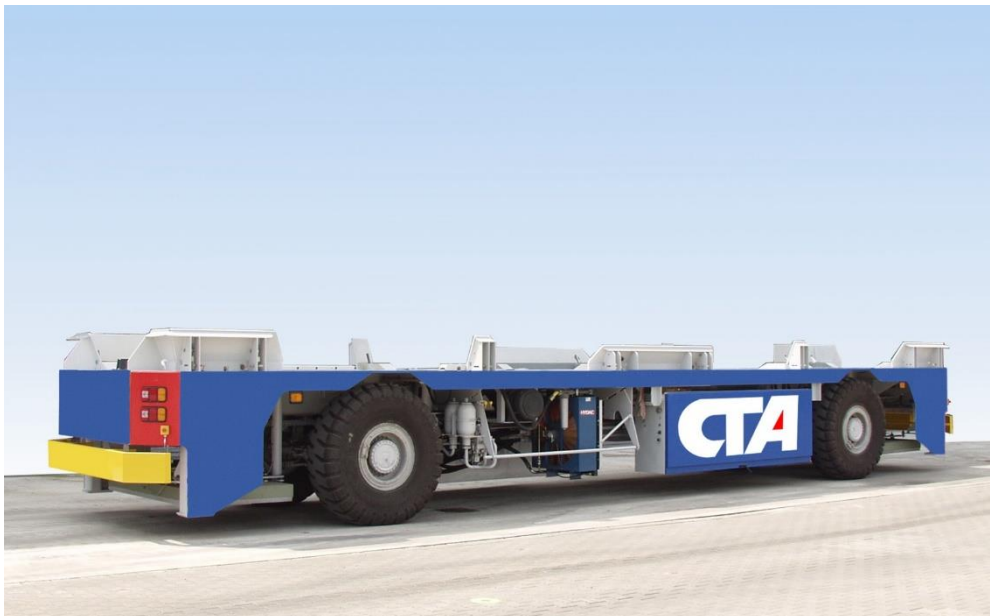
Slika 5: AGV -automatski vođeno vozilo [13]
