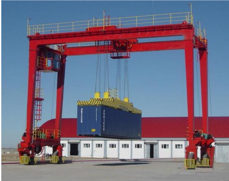
Slika 15: Portalni prijenosnik velikog raspona [8]
