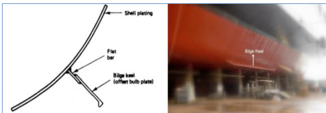
Slika 18. Ljuljna kobilica - primjer pasivnih stabilizatora [16]
