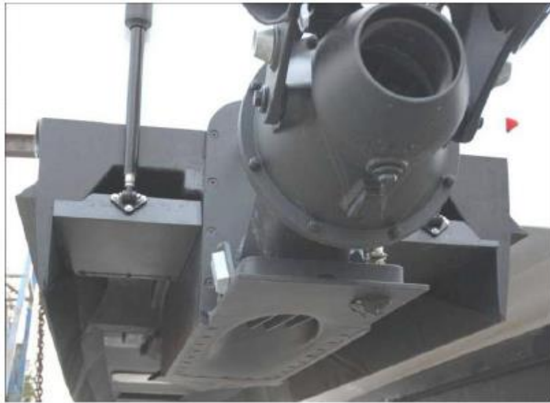
Slika 15. Vodeni propulzor [preuzeto sa www.seseu.com ]
