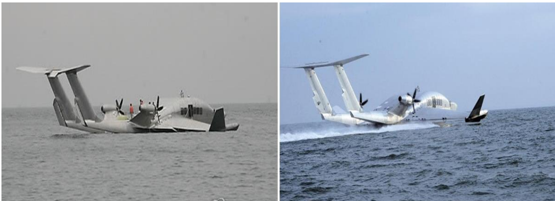
Slika 12. Plovilo sa WIG efektom [preuzeto sa www.wigcraft.com ]
