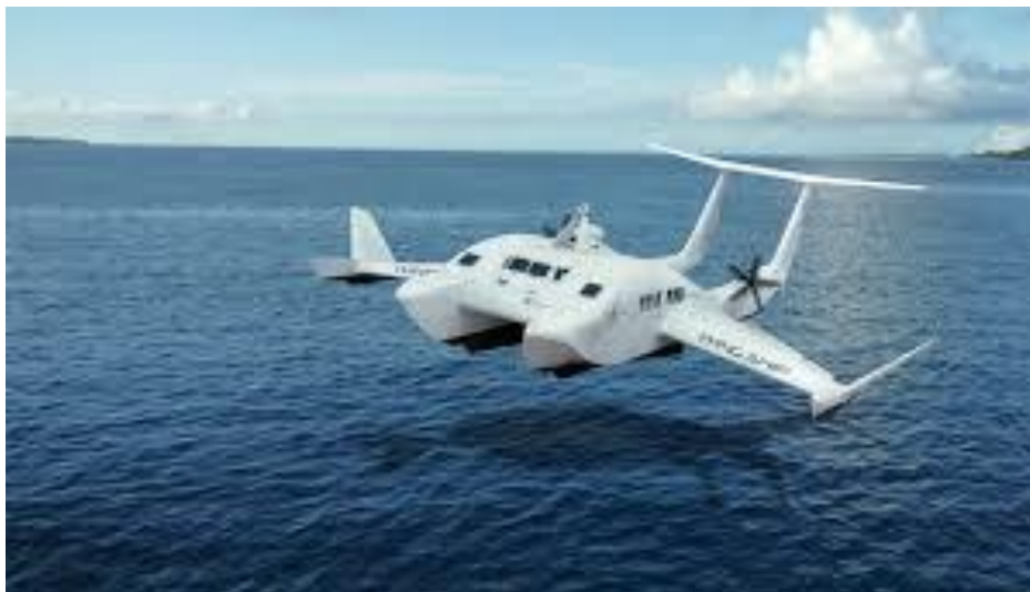
Slika 19. Plovilo sa WIG efektom [preuzeto sa www.wigcraft.com ]
