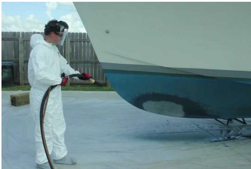
Slika 9. Čišćenje oplata broda mlazom abraziva [12]
