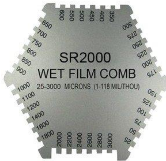
Slika 10. Češalj za ispitivanje mokrog filma premaza [5]
