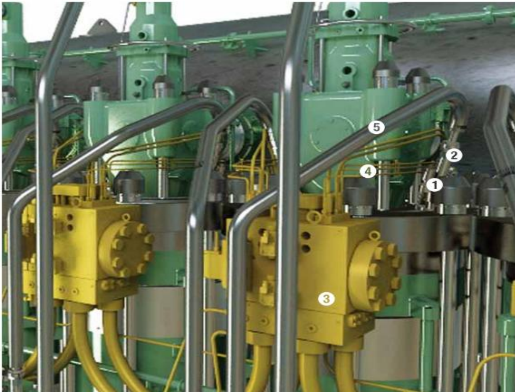
Slika 24. Poklopac cilindra sa svim elementima za ubrizgavanje dvojnog goriva (DF) [1]
