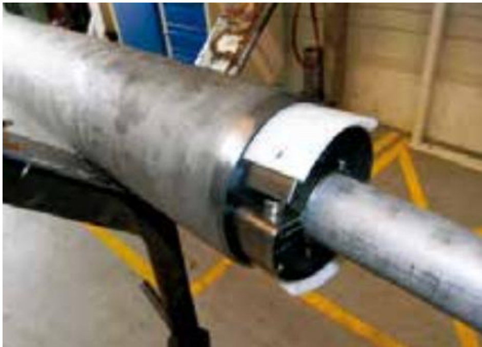
Slika 21. Izrada cijevi sa dvostrukom stjenkom [5]
