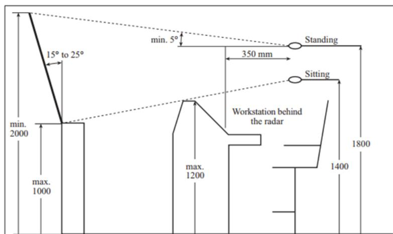
Slika 8 Shematski prikaz minimalne vidljivosti s navigacijskog mosta
