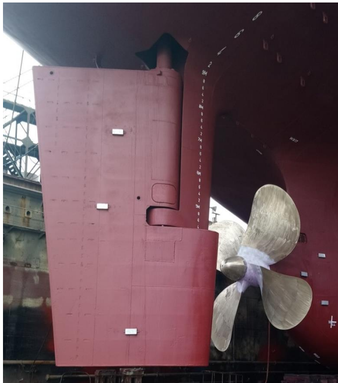
Slika 18. Vijak i kormilo M/T Primjer 1
