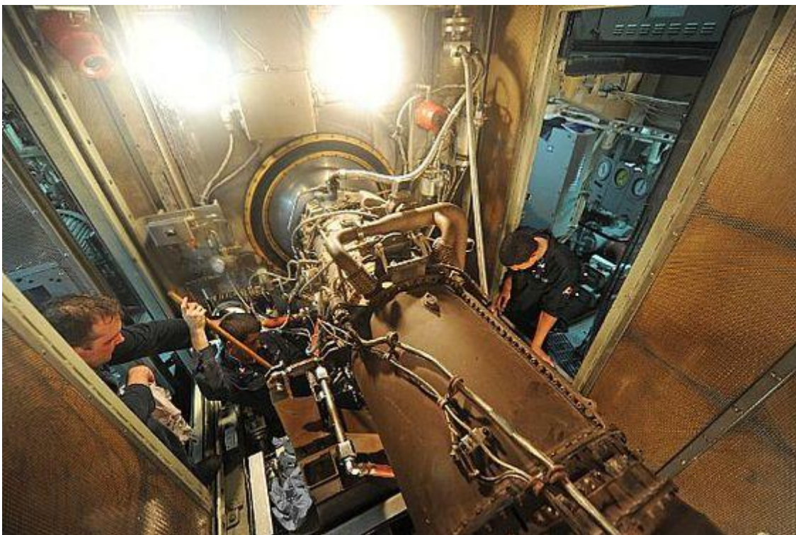
Slika 12. Servisiranje plinske turbine u brodskom postrojenju [12]
