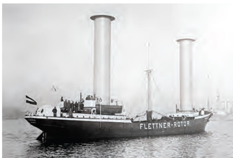
Slika 19. Brod Baden-Baden sa Flettnerovim rotorom [2]
