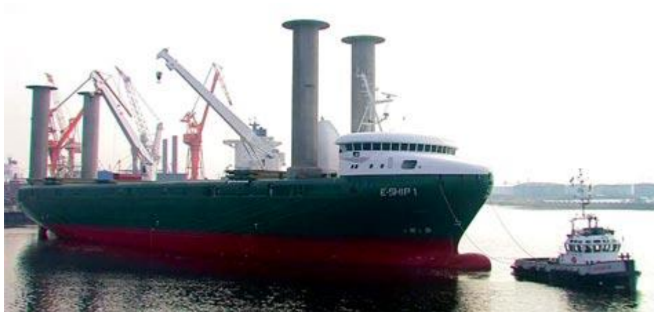
Slika 20. E-ship 1 sa četiri Flettnerova rotora[11]
