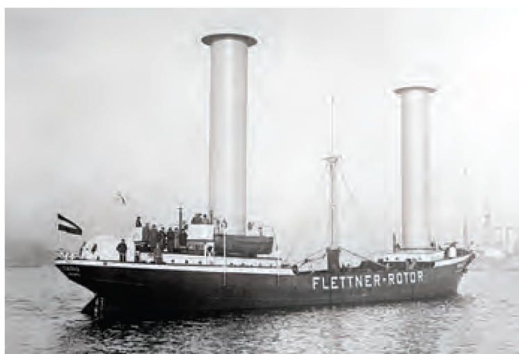
Slika 19. Brod Baden-Baden sa Flettnerovim rotorom [2]
