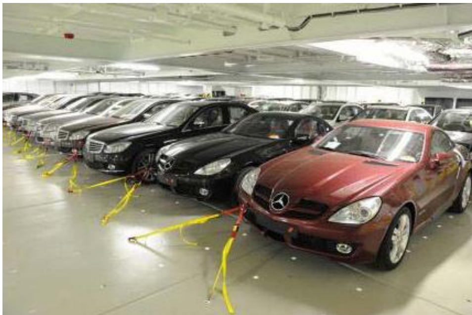
Slika 14. Prikaz osiguranja vozila žičanim načinom [6]
