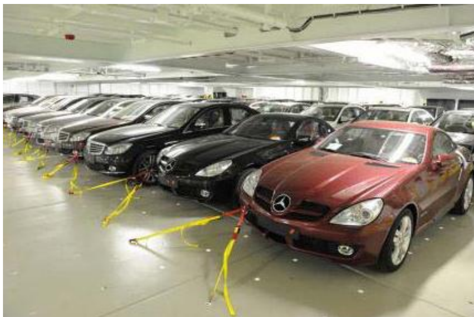
Slika 14. Prikaz osiguranja vozila žičanim načinom [6]
