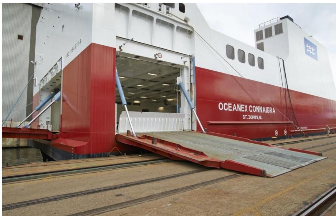
Slika 9. Primjer bočne i krmene rampe [7].
