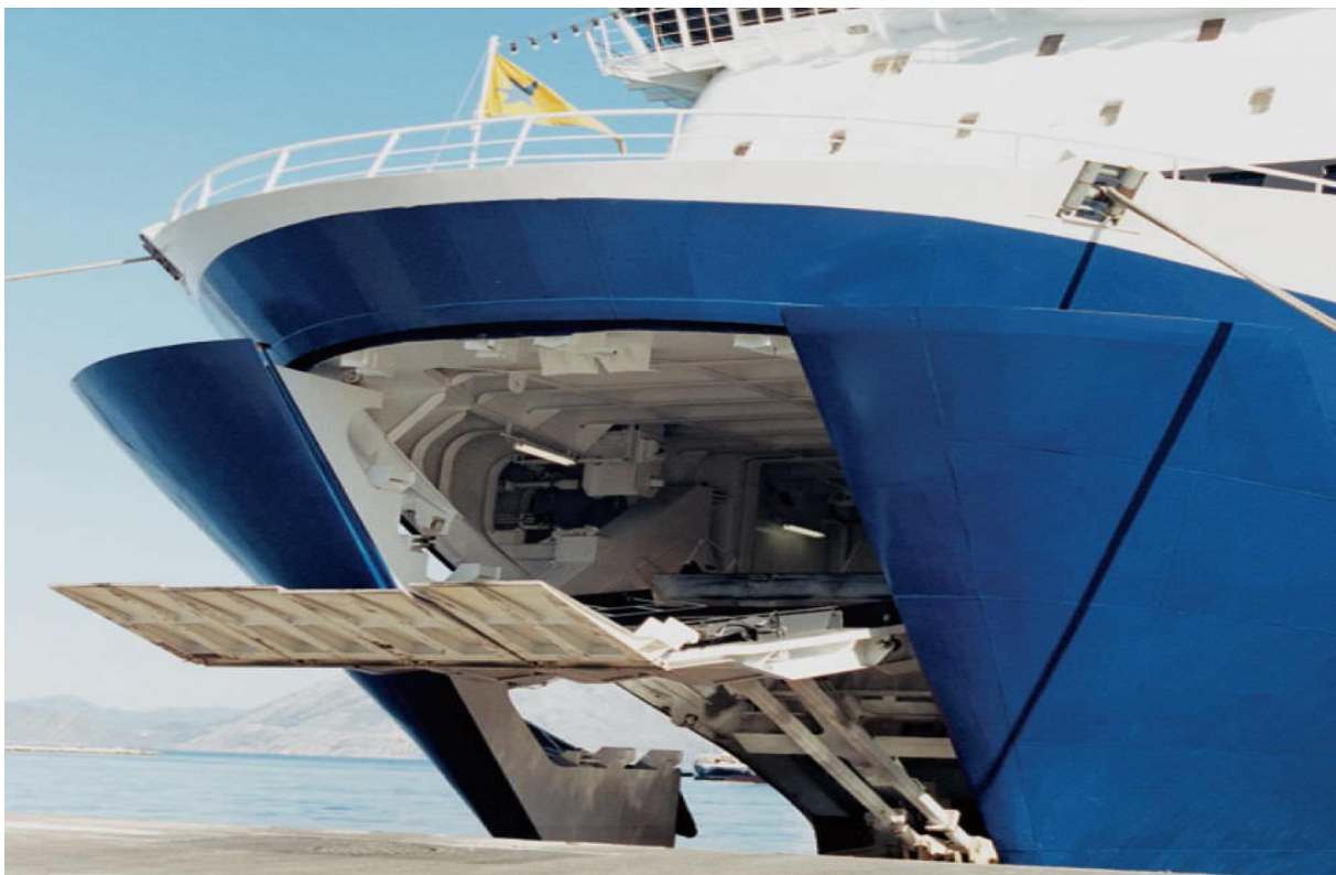
Slika 10. Pramčana višesekcijska rampa [6]
