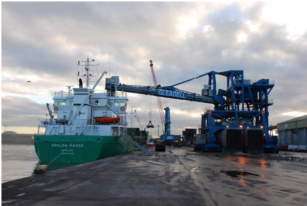
Slika 5. Pokretni mosni brodokrcavač [6]
