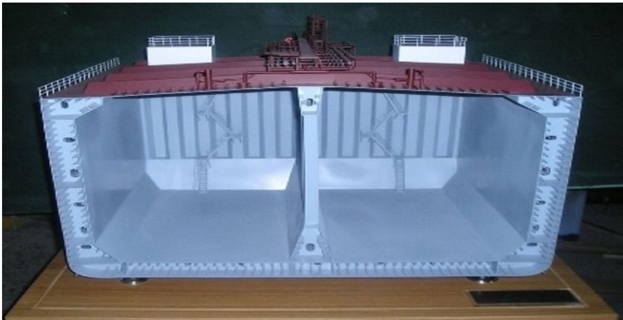
Slika 23. Maketni prikaz presjeka broda za prijevoz kemikalija [6]
