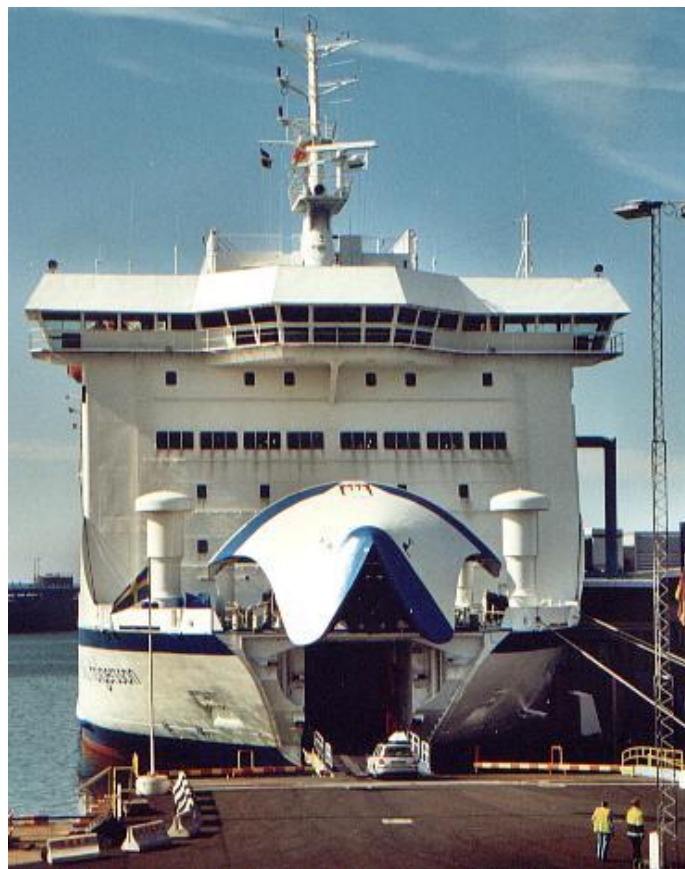
Slika 11. Pramčana aksijalna rampa [6]
