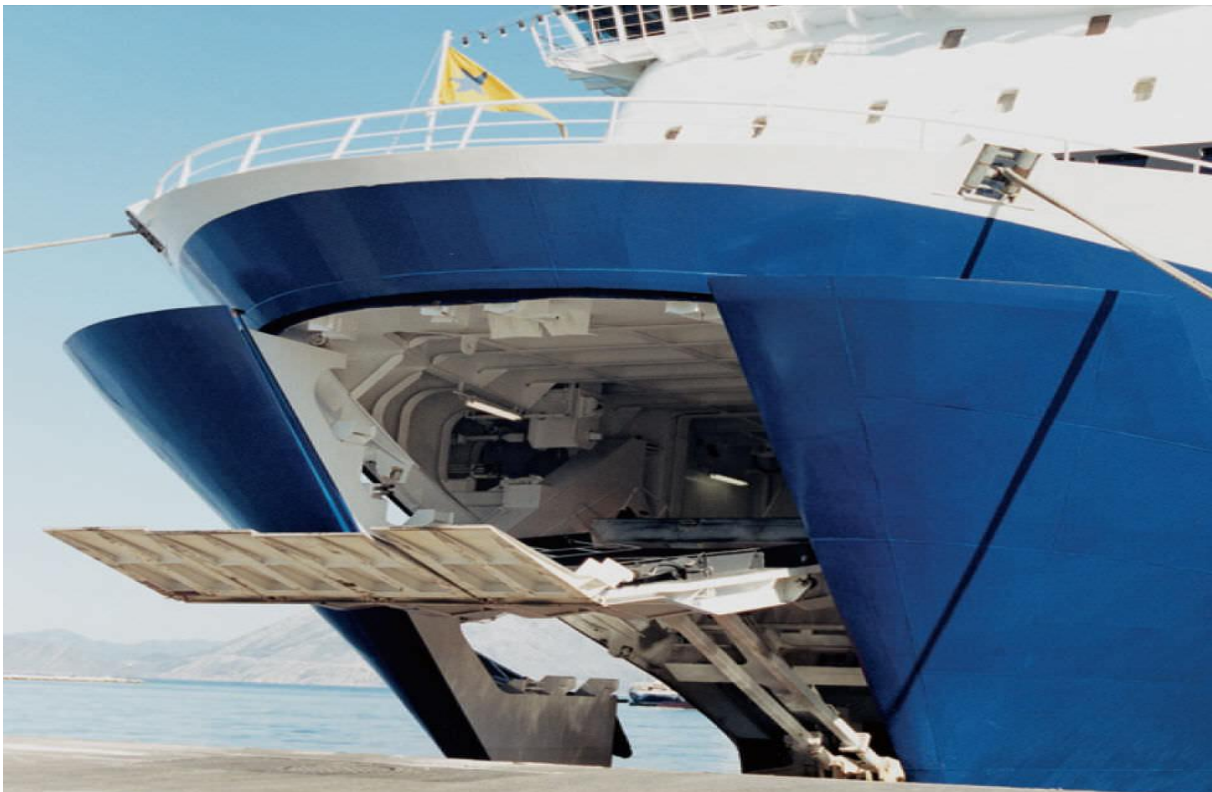
Slika 10. Pramčana višesekcijska rampa [6]
