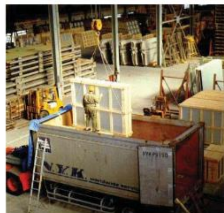
Slika 5. Kontejner s otvorenim krovom i stranicama
