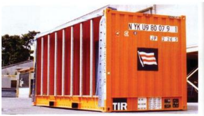
Slika 5. Kontejner s otvorenim krovom i stranicama
