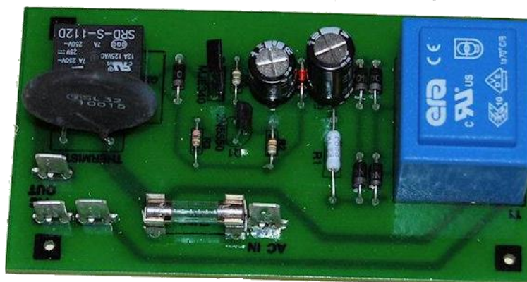
Slika 4.1 Jednoslojna tiskana pločica
