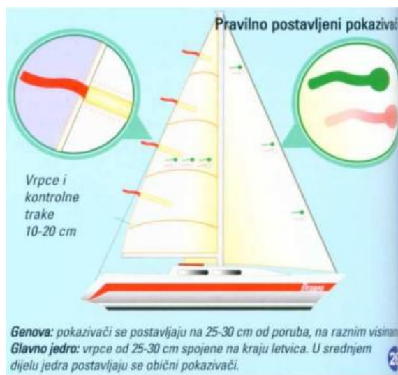
Slika 15. Pravilno postavljeni pokazivači vjetra [3]
