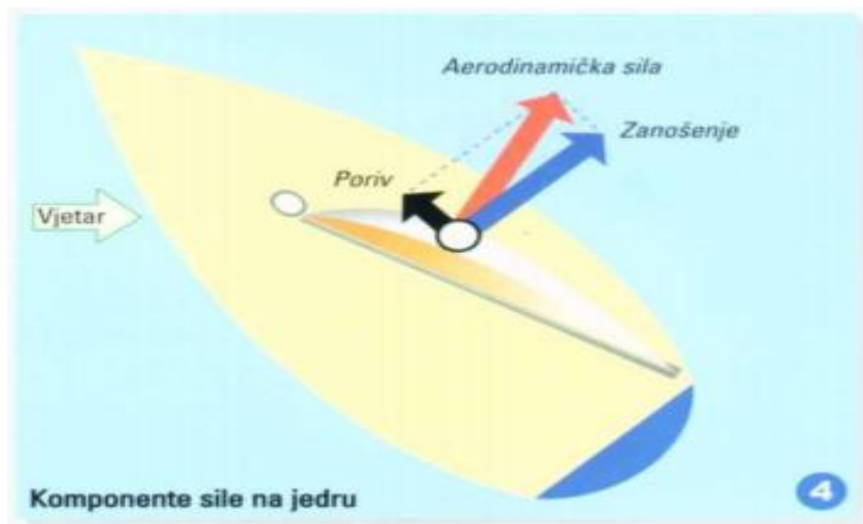
Slika 5. Komponente sile na jedru [3]
