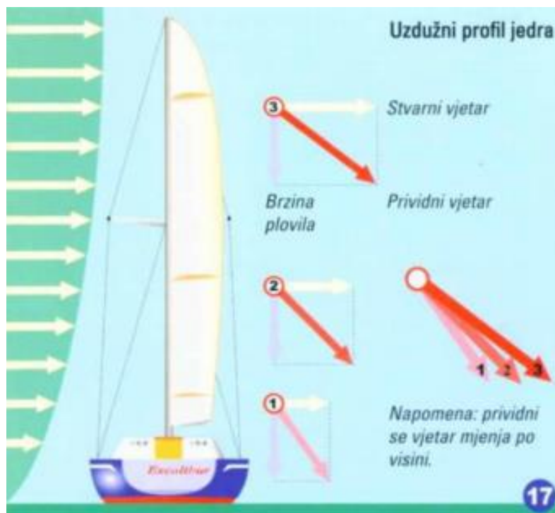
Slika 8. Uzdužni profil jedra [3]
