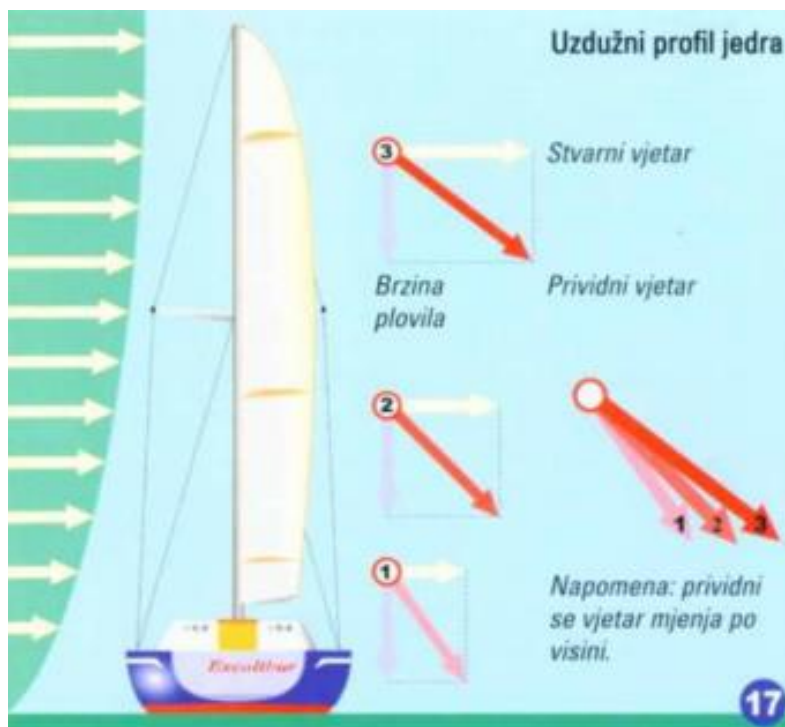
Slika 8. Uzdužni profil jedra [3]
