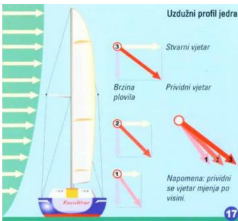
Slika 8. Uzdužni profil jedra [3]
