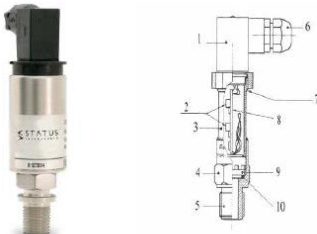
Slika 24. Kapacitativni davač tlaka s elektroničkom jedinicom [3]
