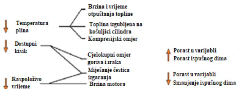
Slika 21. Parametri dizelskih motora koji utječu na formiranje čade i oksidaciju [2]
