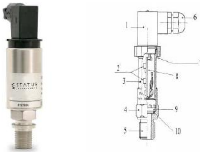
Slika 24. Kapacitivni davač tlaka s elektroničkom jedinicom [3]
