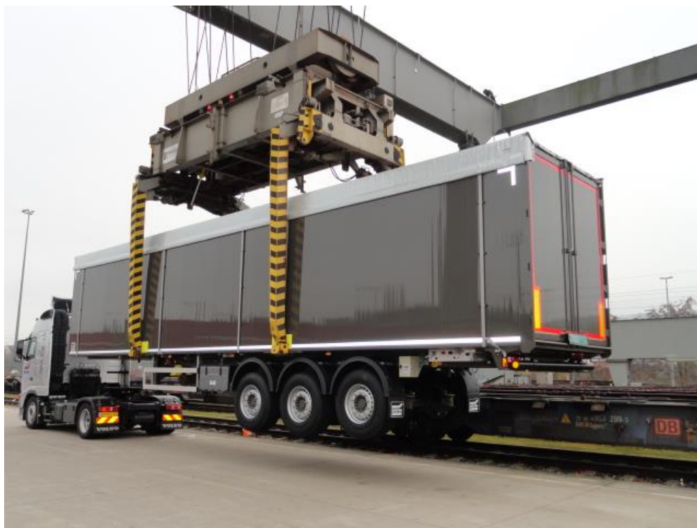
Slika 14: Huckepack B vertikalna tehnologija
