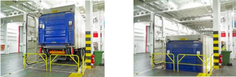
Slika 9. Proces spuštanja unutarnjeg dizala[24]
