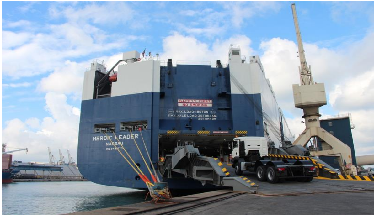
Slika 8. Otklonjena krmena rampa ro-ro broda[23]
