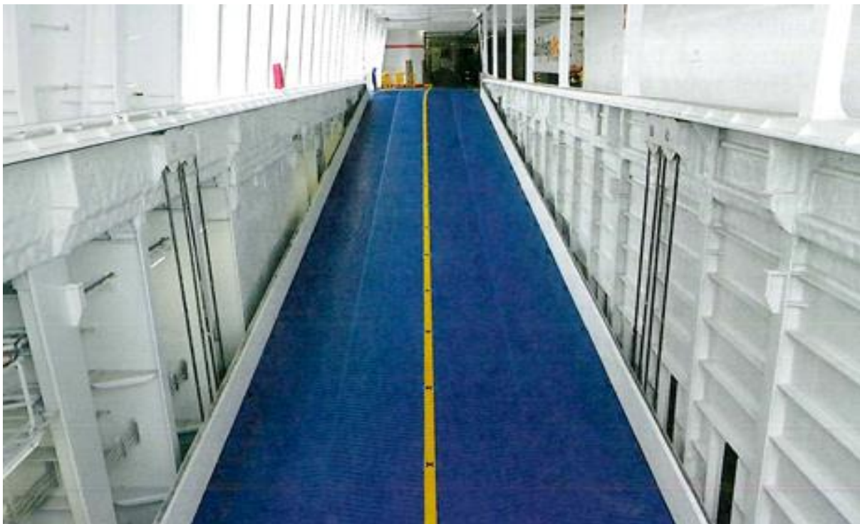
Slika 10. Unutarnja nagibna rampa[25]
