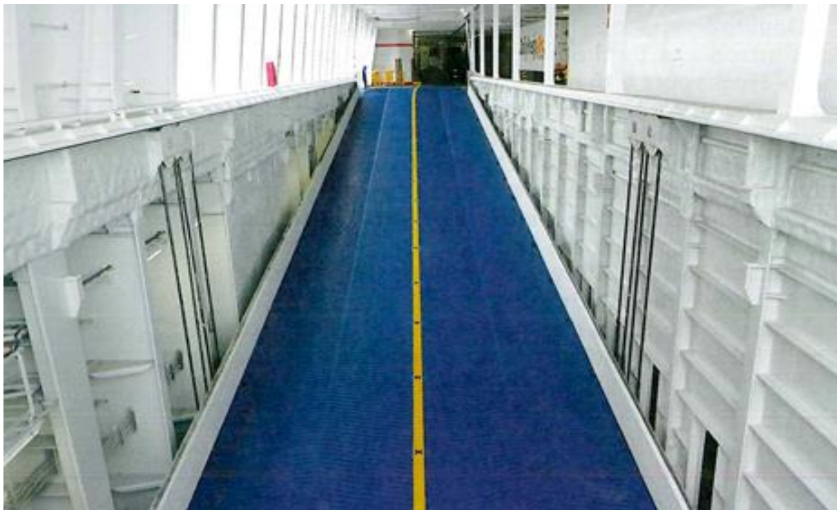
Slika 10. Unutarnja nagibna rampa[25]
