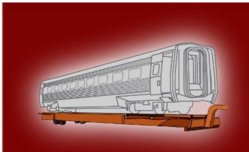
Slika 5. Spuštena ro-ro prikolica[22]
