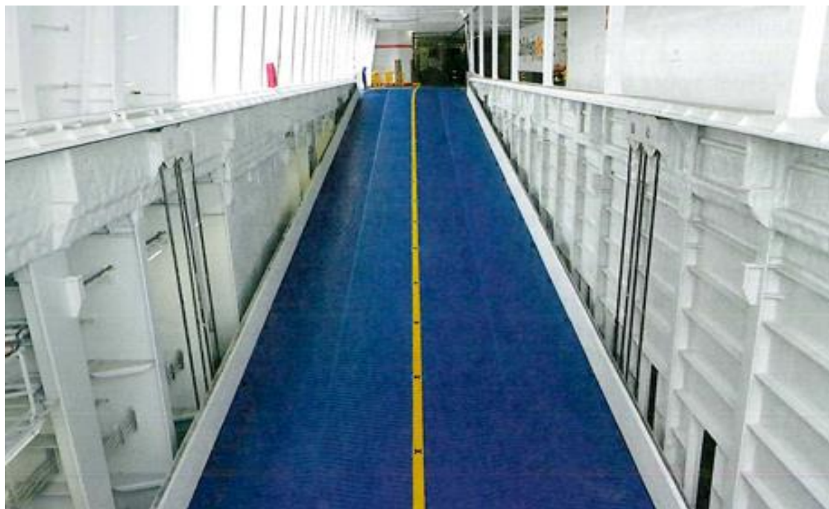
Slika 10. Unutarnja nagibna rampa[25]
