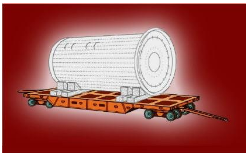
Slika 4. Spuštena sklopiva ro-ro prikolica[22]
