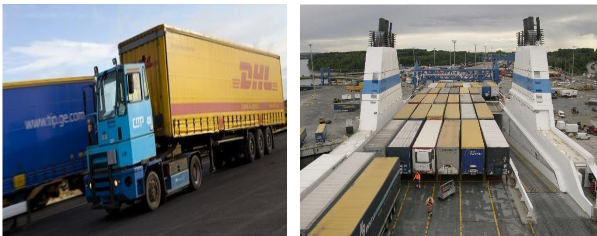
Slika 3. Lučka manipulacija prikolicama cestovnog prometa[21]
