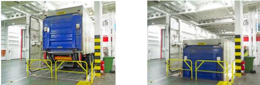
Slika 9. Proces spuštanja unutarnjeg dizala[24]
