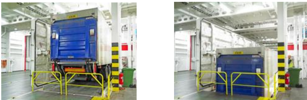
Slika 9. Proces spuštanja unutarnjeg dizala[24]
