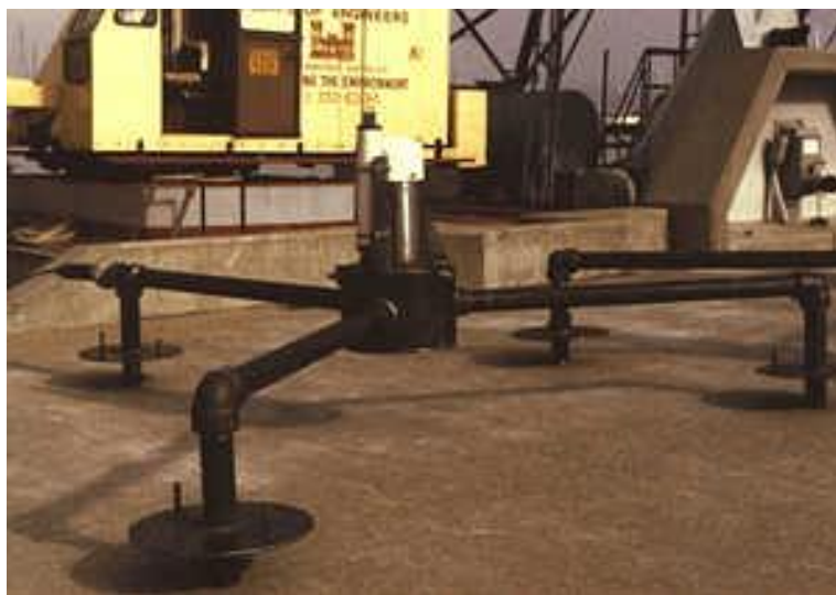
Slika 16. Instalacija za mjerenje visine valova pomoću tlačnih mjerila (San Francisco, 1998)
