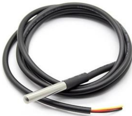
Slika 31. Vodootporna termalna sonda DS18B20
