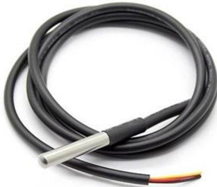
Slika 31. Vodootporna termalna sonda DS18B20
