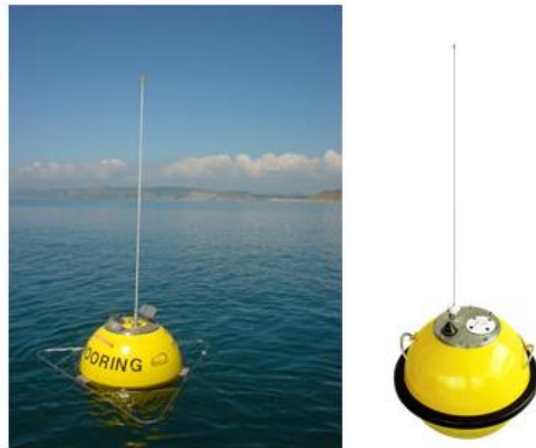
Slika 17. plutača za mjerjenje površinskih valova<sup>2</sup>
