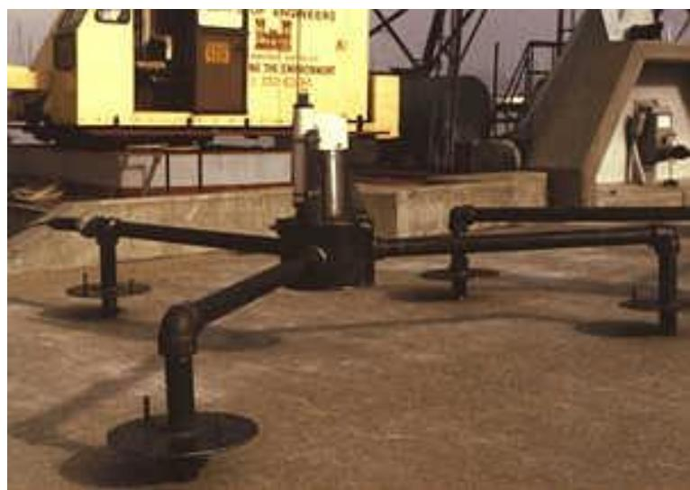
Slika 16. Instalacija za mjerjenje visine valova pomoću tlačnih mjerila (San Francisco, 1998)
