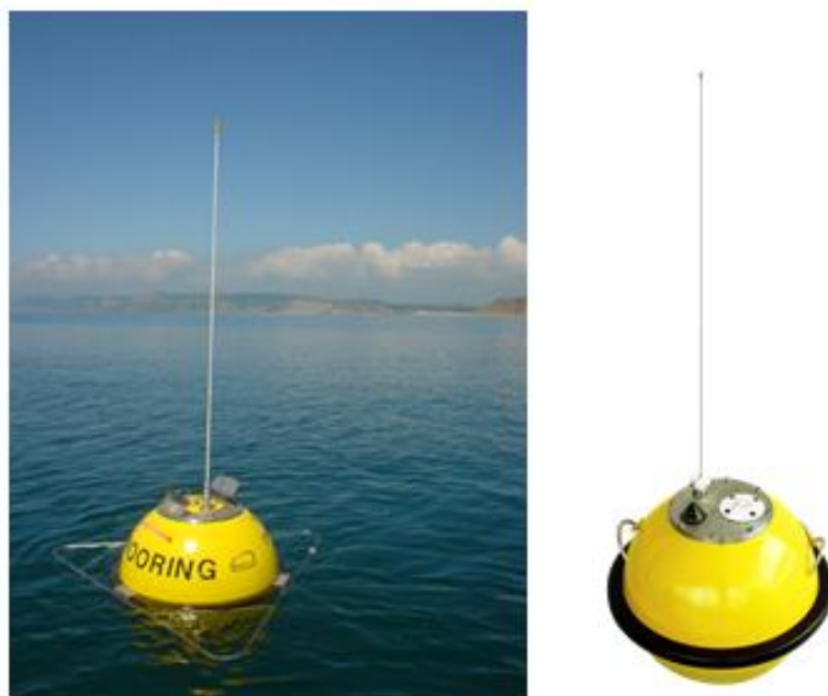
Slika 17. plutača za mjerenje površinskih valova 2
