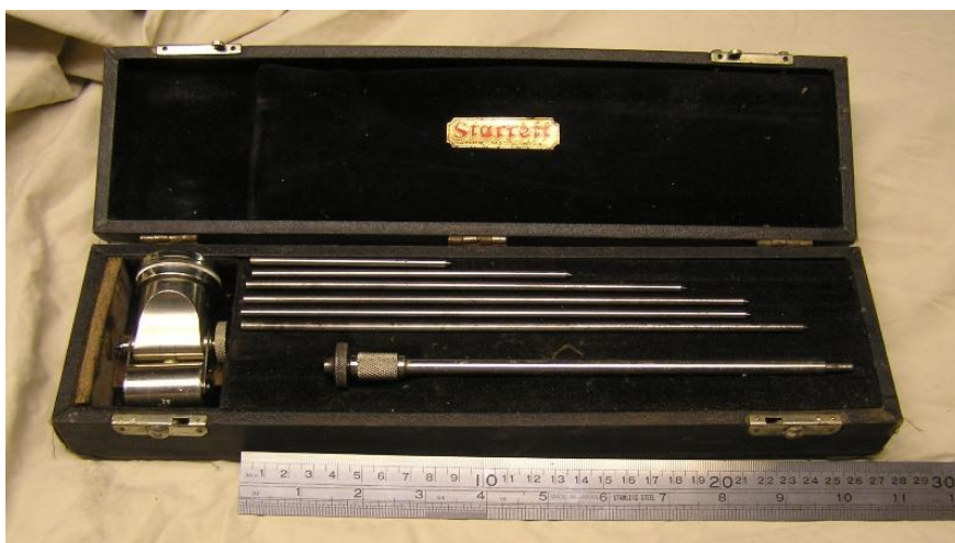
Slika 24. Indikator otklona koljenastog vratila [2]
