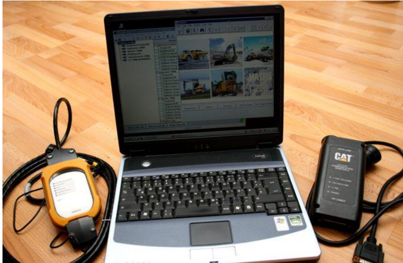
Slika 11. Laptop s instaliranim Caterpillar servisnim alatom [2]
