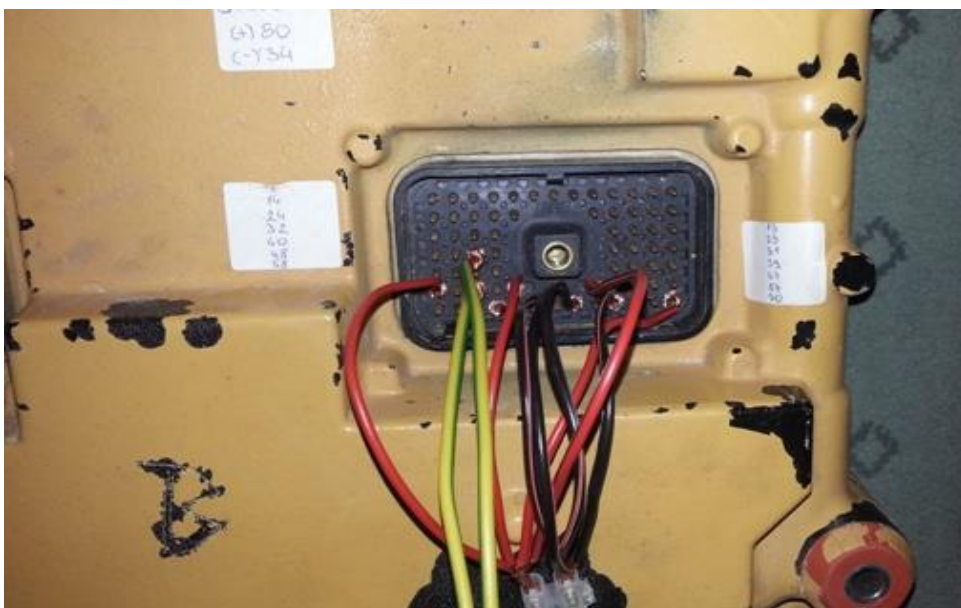
Slika 53. Izvođenje pinova sa ECU-a
