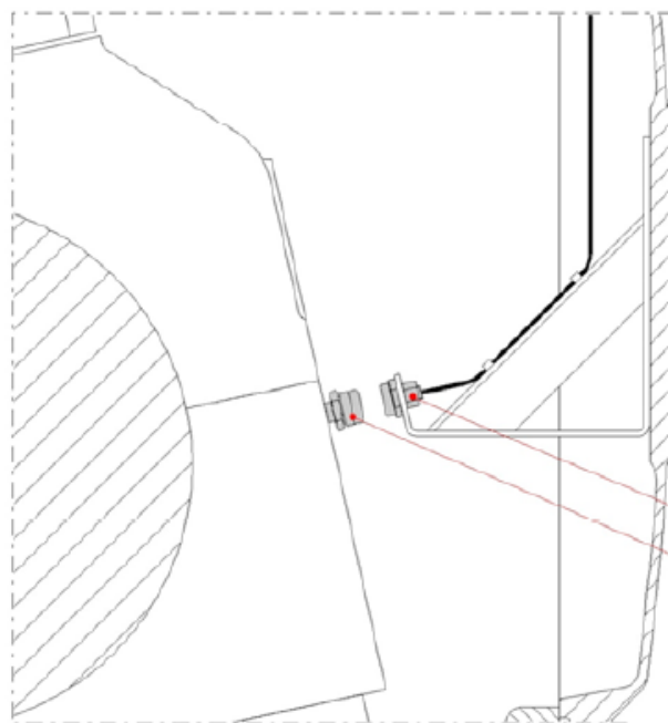
Slika 32. Instalacija bežičnog senzora [14]
