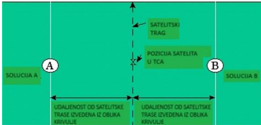
Slika 12. Objašnjenje Dopplerove obrade [19]
