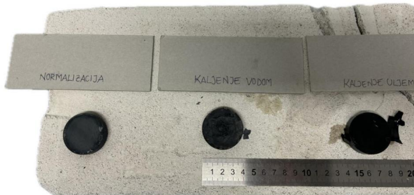
Slika 20. Uzorci toplinske obrade normalizacije, kaljenja vodom i kaljenja uljem.
