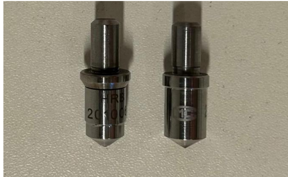
Slika 16. Penetratori za HRC i HRB metodu.
