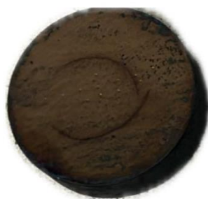
Slika 21. Pukotina na uzorku "Kaljenje vodom".
