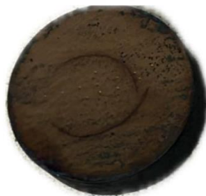
Slika 21. Pukotina na uzorku "Kaljenje vodom".
