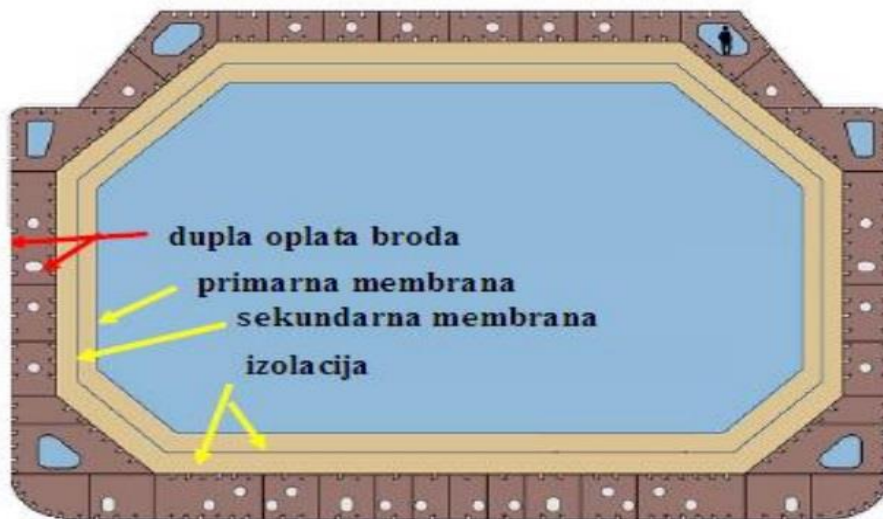
Slika 14. Izvedba membranskog spremnika (Simon, 2023)
