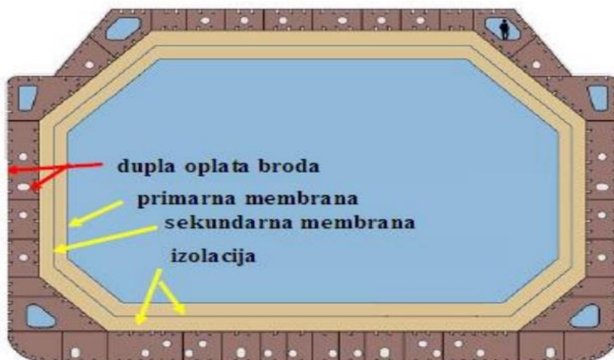
Slika 14. Izvedba membranskog spremnika (Simon, 2023)
