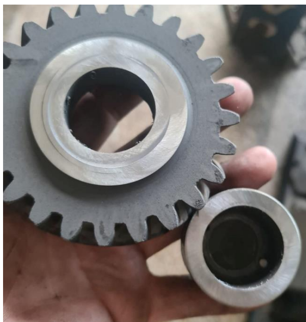
Slika 13. Odvojeni zupčanik i vratilo nakon ravnanja
