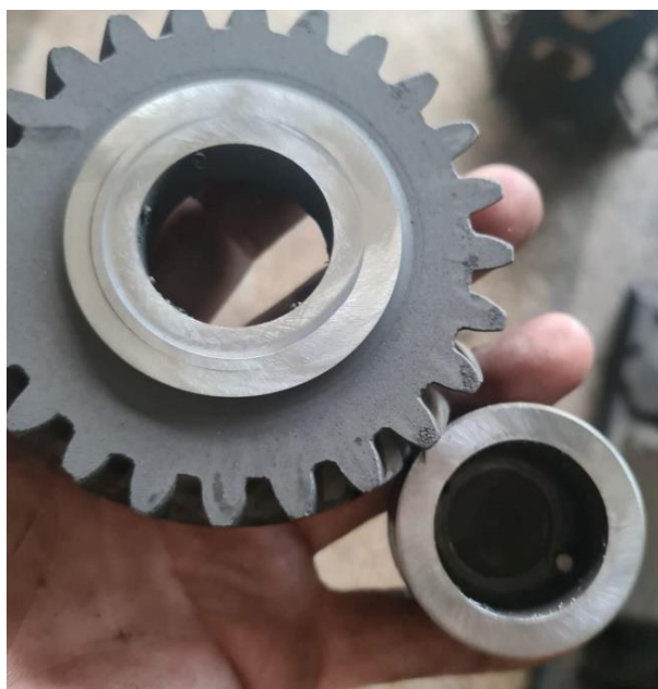
Slika 13. Odvojeni zupčanik i vratilo nakon ravnanja
