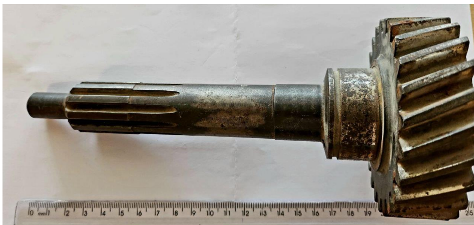
Slika 10. Prikaz glavnog zupčanog prijenosa prije rezanja
