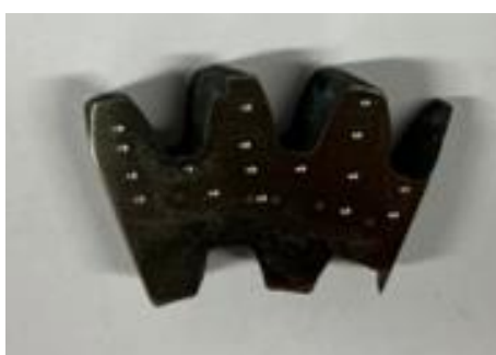
Slika 18. Primjer uzorka za ispitivanja tvrdoće
